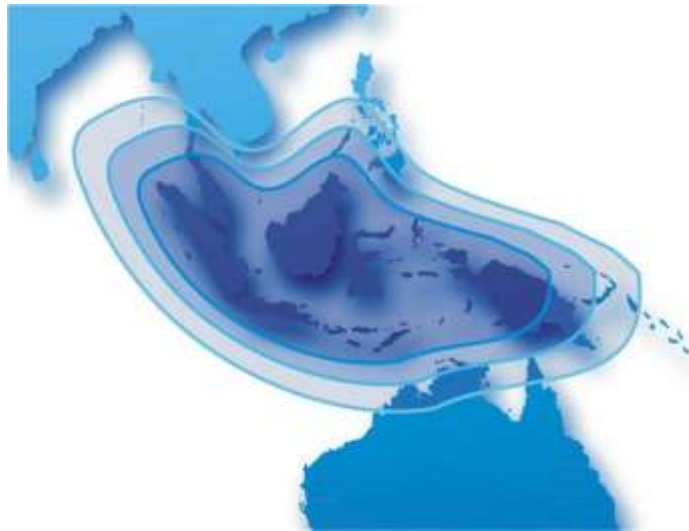
Рис. 25. Рабочие зоны ИСЗ PALAPA-D (113° в.д.) в Ku-диапазоне частот
