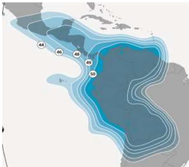
Рис. 92. ЭИИМ (дБ Вт) в рабочих зонах (Центральная Америка и Андский район) ИСЗ SES-6 (40,5° з.д.) в Ku-диапазоне частот
