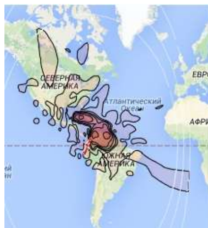
Рис. 5. Рабочие зоны (Венесуэла) ИСЗ VENESAT-1 (78° з.д.) в Ku-диапазоне частот
