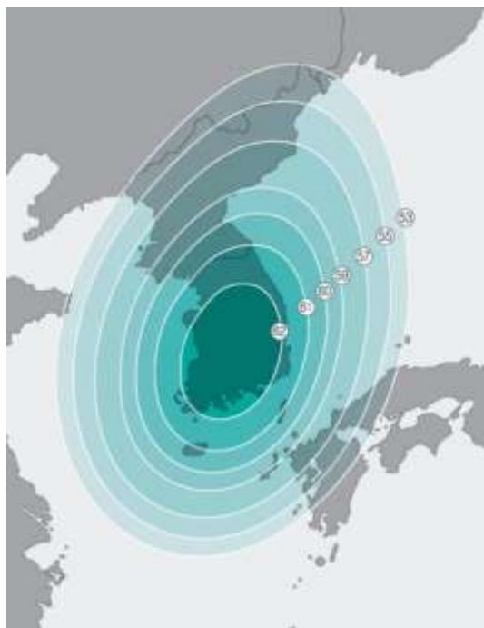
Рис. 3. ЭИИМ (дБВт) в рабочих зонах ИСЗ KOREASAT-6 (116° в.д.) в Ku-диапазоне частот
