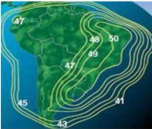
Рис. 65. ЭИИМ (дБ·Вт) в южноамериканской рабочей зоне ИСЗ GALAXY-28 (INTELSAT-A8, 89° з.д.) в Ku-диапазоне частот
