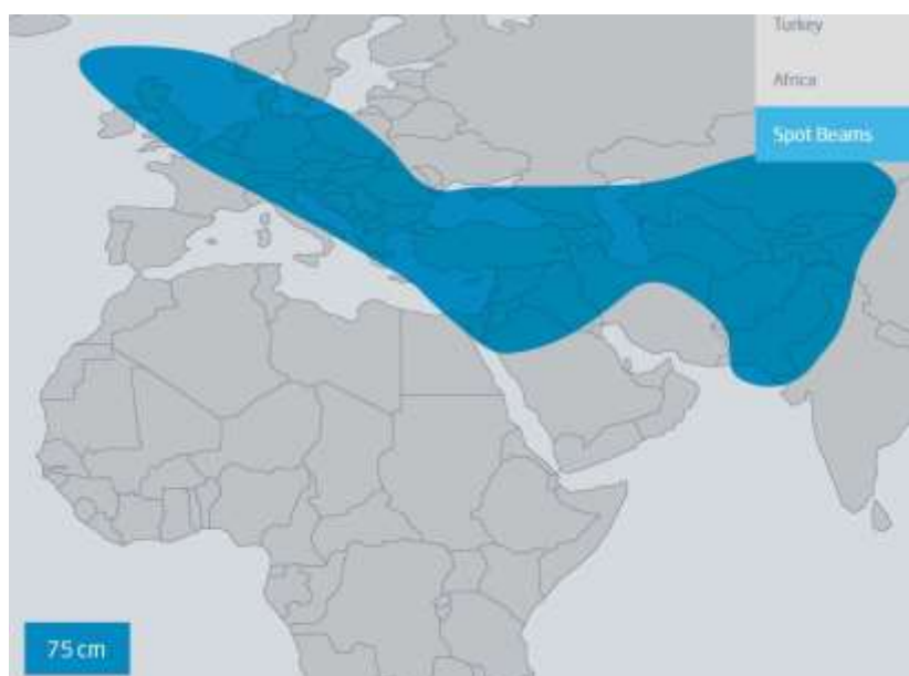
Рис. 30. Рабочие зоны ИСЗ TURKSAT-4B (50° в.д.) в Ка-диапазоне частот
