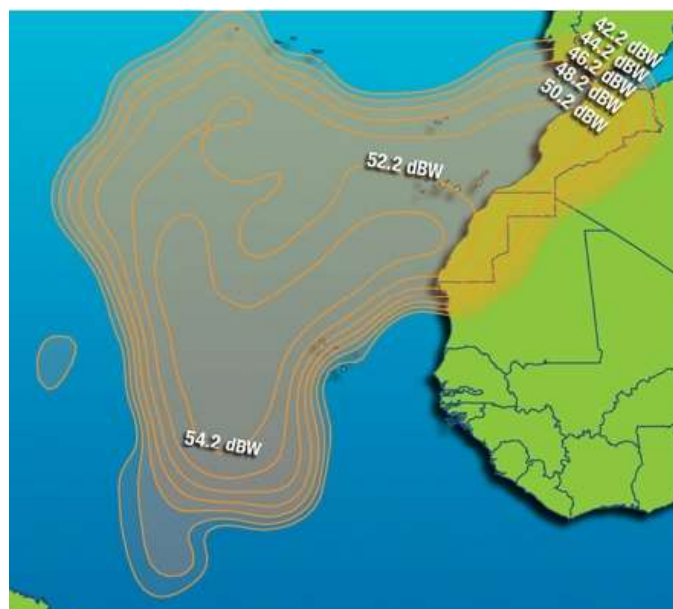
Рис. 80. ЭИИМ (дБ·Вт) в рабочих зонах ИСЗ INTELSAT-25 (31,5° з.д.) в С-диапазоне частот
