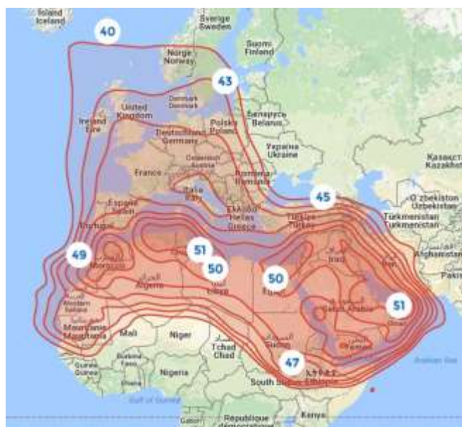
Рис. 5. Рабочие зоны (BSS) ИСЗ ARABSAT-4B (26° в.д.) в Ку-диапазоне частот
