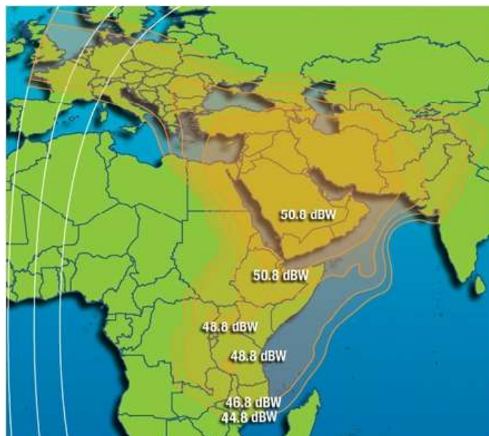
Рис. 95. ЭИИМ (дБ·Вт) в рабочих зонах (Европа, Ближний и Средний Восток и восточное побережье Африки) ИСЗ INTELSAT-22 (72° в.д.) в Ku-диапазоне частот
