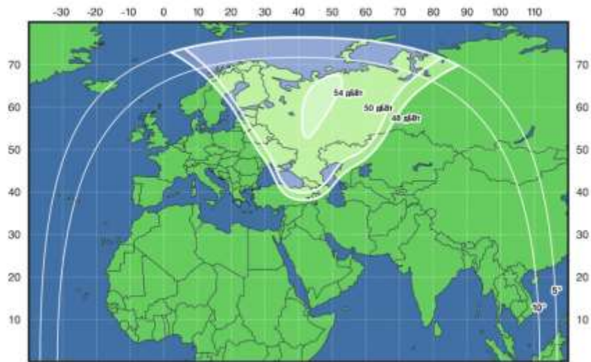
Рис. 41. ЭИИМ (дБВт) в рабочей зоне (1-й фиксированный луч) ИСЗ ЭКСПРЕСС-АМ7 (40° в.д.) в Ки-диапазоне частот
