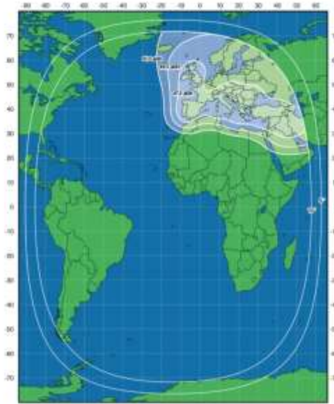
Рис. 49. ЭИИМ (дБ·Вт) в рабочей зоне (1-й фиксированный луч) ИСЗ ЭКСПРЕСС-АМ8 (14° з.д.) в Ки-диапазоне частот
