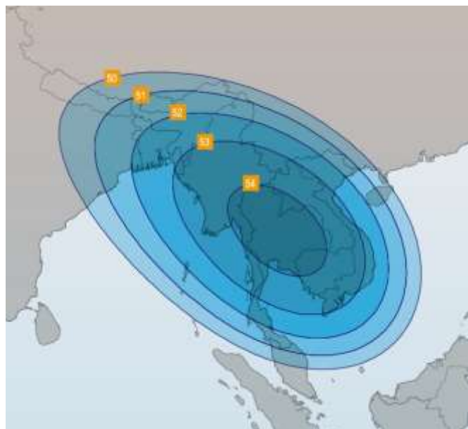
Рис. 18. Рабочие зоны (а) и ЭИИМ (дБ·Вт) в рабочих зонах (б – АТР и в – морская в С-диапазоне частот, г – западная, д - северная, е – южная и-ж – перенацеливаемая в Ku-диапазоне частот) ИСЗ APSTAR-9/MYSAT-1 (142° в.д.)
