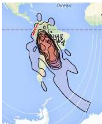
Рис. 4. Рабочие зоны (Южная Америка) ИСЗ VENESAT-1 (78° з.д.) в Ku-диапазоне частот
