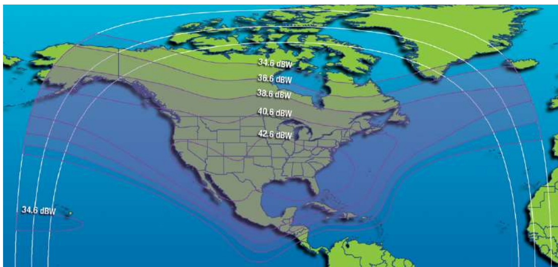
Рис. 74. ЭИИМ (дБ·Вт) в рабочих зонах ИСЗ GALAXY-17 (91° з.д.) в С-диапазоне частот
