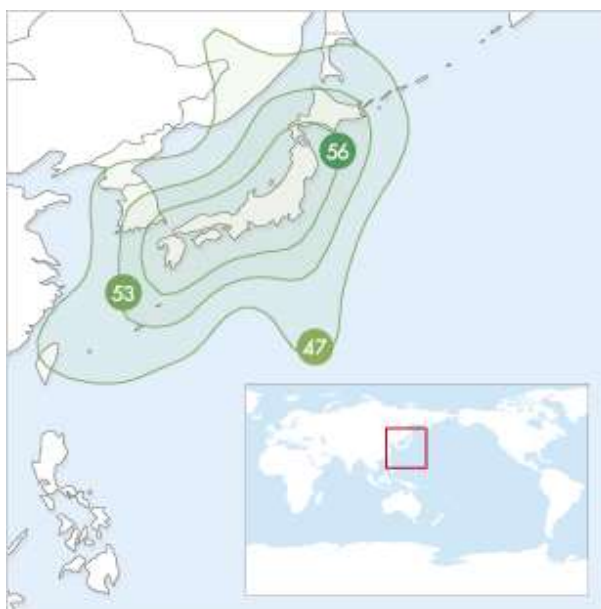
Рис. 13. ЭИИМ (дБ·Вт) в рабочих зонах (Япония) ИСЗ SUPERBIRD-7 (144° в.д.) в Ku-диапазоне частот
