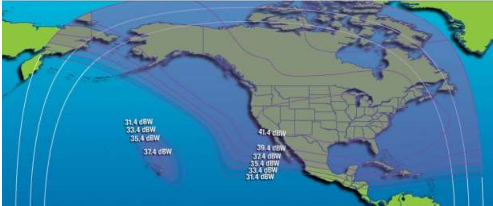
Рис. 70. ЭИИМ (дБ·Вт) в рабочих зонах (горизонтальная поляризация) ИСЗ GALAXY-14 (125° з.д.) в С-диапазоне частот
