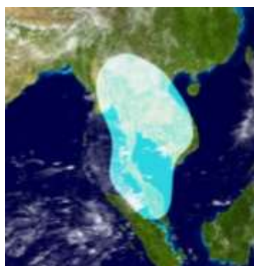
Рис. 29. Рабочие зоны (а – все, б – Индия и в – Таиланд) ИСЗ THAICOM-8 (78,5° в.д.) в Ku-диапазоне частот
