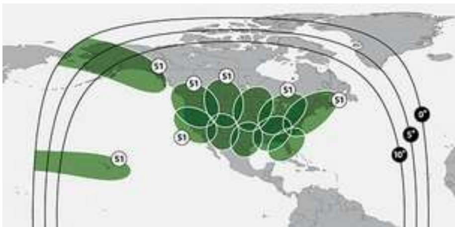
Рис. 29. ЭИИМ (дБ Вт) в рабочих зонах ИСЗ AMC-15 (105° з.д.) в Ka-диапазоне частот
