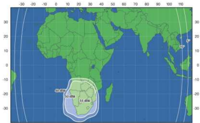
Рис. 45. ЭИИМ (дБ-Вт) в рабочей зоне (2 вариант перенацеливаемого луча) ИСЗ ЭКСПРЕСС-АМ7 (40° в.д.) в Ки-диапазоне частот
