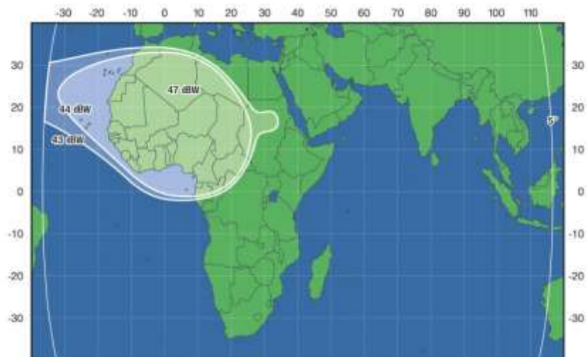
Рис. 38. ЭИИМ (дБ-Вт) в рабочей зоне (1 вариант перенацеливаемого луча) ИСЗ ЭКСПРЕСС-АМ7 (40° в.д.) в С-диапазоне частот
