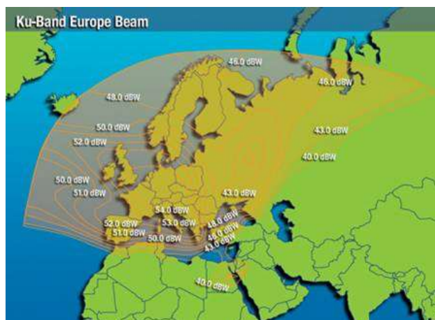
Рис. 15. ЭИИМ (дБ·Вт) в рабочей зоне на Европу ИСЗ INTELSAT-12 (PAS-12, 45° в.д.) в Ку-диапазоне частот
