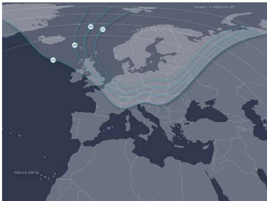
Рис. 6. ЭИИМ (дБ·Вт) в рабочих зонах (K1) ИСЗ THOR-6 (0,8° з.д.) в Ки-диапазоне частот
