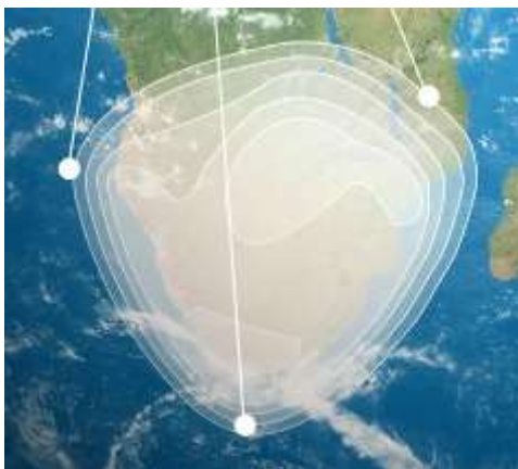
Рис. 3. Рабочие зоны (а – ME, б – SA) ИСЗ HELLAS-SAT-2 (39° в.д.) в Ku-диапазоне частот
