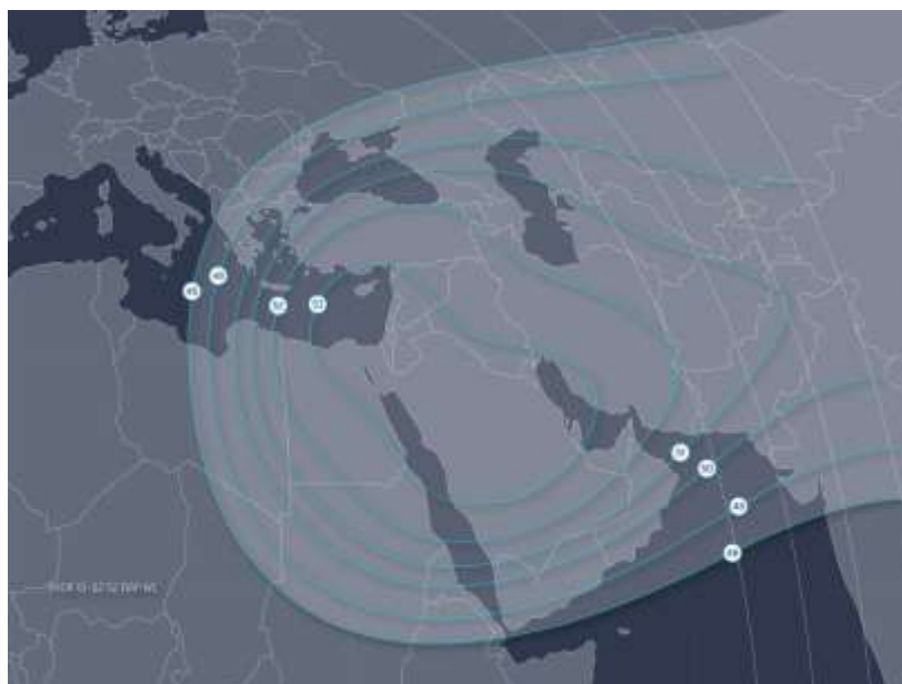
Рис. 2. ЭИИМ (дБ·Вт) в рабочих зонах (луч 2, горизонтальная поляризация) ИСЗ THOR-10-02 (INTELSAT-10-02) (1° з.д.) в Ки-диапазоне частот
