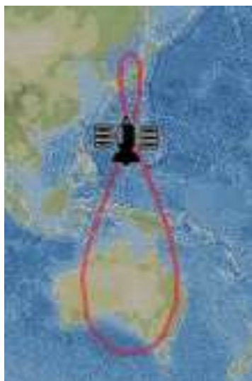
Рис. 5. Подспутниковая трасса ИСЗ МІСНІВІКІ-1 (QZS-1)
