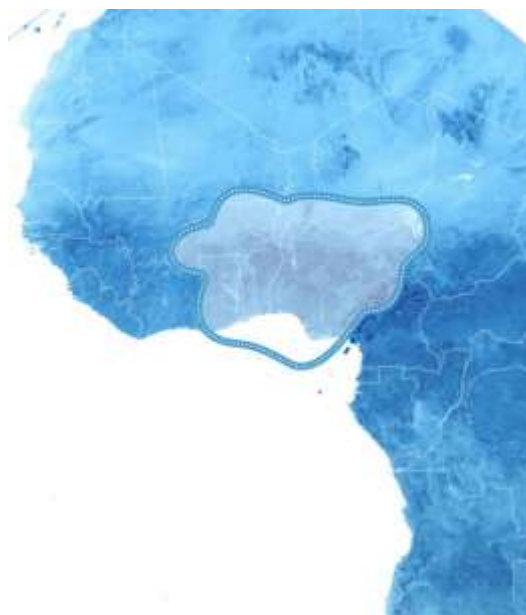
Рис. 39. Рабочие зоны ИСЗ HYLAS-3 (31° в.д.) в Ка-диапазоне частот
