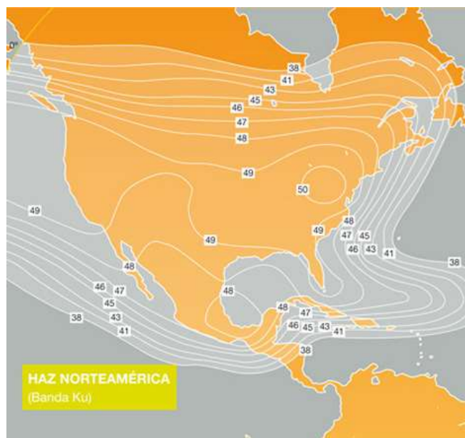
Рис. 28. ЭИИМ (дБ·Вт) в рабочей зоне (на Северную Америку) ИСЗ AMAZONAS-3 (61° з.д.) в Ku-диапазоне частот
