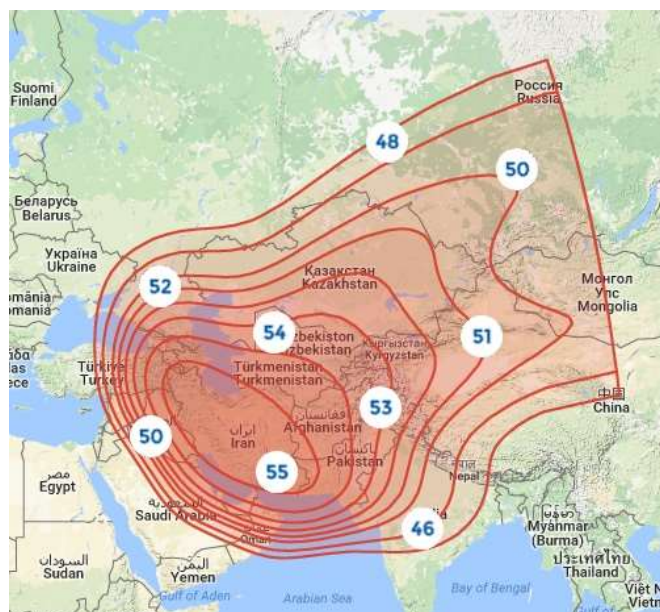
Рис. 23. ЭИИМ (дБ·Вт) в рабочих зонах (BSS, central Asia) ИСЗ ARABSAT-5B (26° в.д.) в Ки-диапазоне частот
