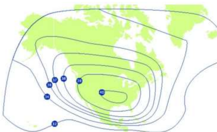
Рис. 50. ЭИИМ (дБ·Вт) в рабочих зонах (а - горизонтальная, б - вертикальная поляризация) ИСЗ GALAXY-3С (95° з.д.) в С-диапазоне частот
