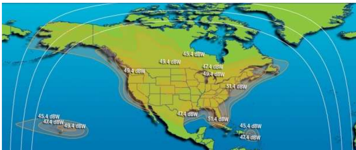
Рис. 73. ЭИИМ (дБ·Вт) в рабочих зонах ИСЗ GALAXY-16 (99° з.д.) в С- (а) и Ку- (б) диапазонах частот
