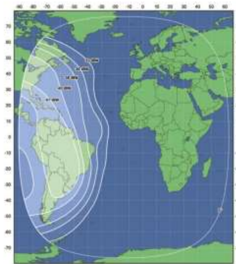
Рис. 48. ЭИИМ (дБ-Вт) в рабочей зоне (американский луч) ИСЗ ЭКСПРЕСС-АМ8 (14° з.д.) в С-диапазоне частот
