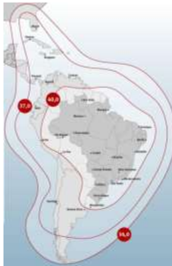
Рис. 6. ЭИИМ (дБ·Вт) в рабочей зоне ИСЗ STAR ONE-C1 (65° з.д.) в С-диапазоне частот
