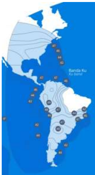
Рис. 22. ЭИИМ (дБ·Вт) в рабочих зонах ИСЗ HISPASAT-30W-6 (-1F) (30° з.д.) в Ku-диапазоне частот
