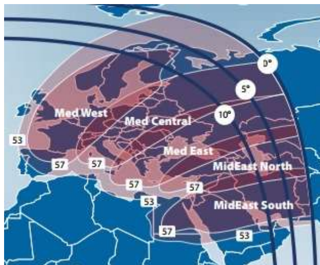
Рис. 52. ЭИИМ (дБ·Вт) в рабочих зонах (восемь узких лучей) ИСЗ TELSTAR-12 VANTAGE (15° з.д.) в Ки-диапазоне частот
