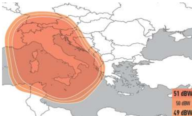
Рис. 63. ЭИИМ (дБ-Вт) в рабочих зонах (а – северо-восточная Африка и Ближний Восток, б – Средиземноморье, Северная Африка и Ближний Восток, в - Америка) ИСЗ EUTELSAT-8 West B (8° з.д.) в Ки-диапазоне частот
