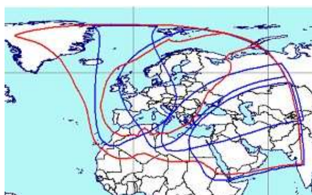
Рис. 10. Рабочие зоны (а) и ЭИИМ (дБ·Вт) в рабочих зонах (б) ИСЗ ATLANTIC BIRD-3 (5° з.д.) в С-диапазоне частот
