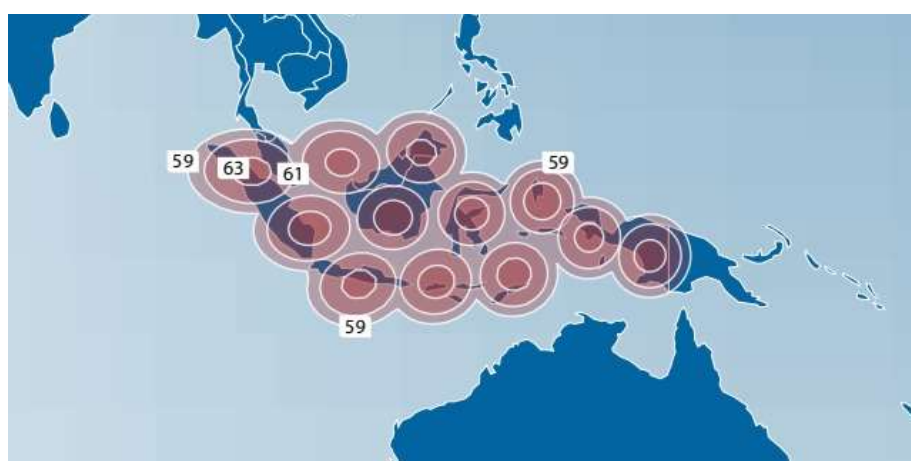
Рис. 24. ЭИИМ (дБ·Вт) в рабочих зонах (12 узких лучей) ИСЗ APSTAR-5C/TELSTAR-18 VANTAGE (138° в.д.) в Ку-диапазоне частот
