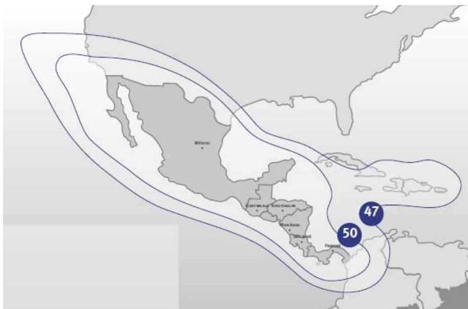
Рис. 20. ЭИИМ (дБ·Вт) в рабочих зонах (Латинская Северная Америка) ИСЗ HISPASAT-84W-2 (STAR ONE-D1) (84° з.д.) в Ки-диапазоне частот
