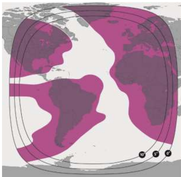
Рис. 30. Рабочие зоны ИСЗ NSS-10 (АМС-12, 37,4° з.д.) в С-диапазоне частот
