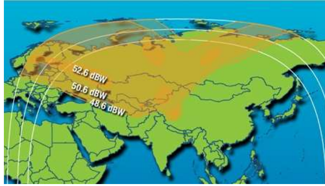
Рис. 78. ЭИИМ (дБВт) в рабочих зонах (Россия) ИСЗ HORIZONS-2 (85° в.д.) в Ки-диапазоне частот
