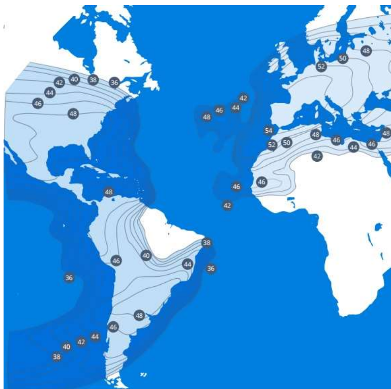
Рис. 7. ЭИИМ (дБ-Вт) в рабочих зонах ИСЗ HISPASAT-30W-5 (-1E) (30° з.д.) в Ки-диапазоне частот
