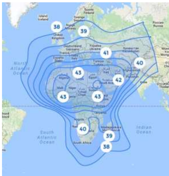
Рис. 26. ЭИИМ (дБ·Вт) в рабочих зонах (Extended EMEA) ИСЗ ARABSAT-5C (20° в.д.) в С-диапазоне частот
