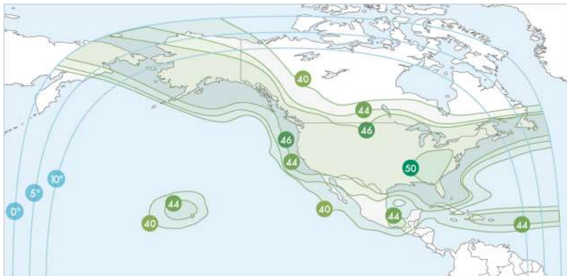
Рис. 6. ЭИИМ (дБ·Вт) в рабочих зонах ИСЗ HORIZONS-1 (127° з.д.) в Ku-диапазоне частот
