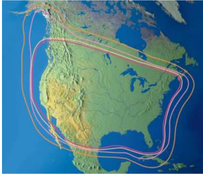
Рис. 59. Рабочая зона ИСЗ системы компании DirecTV в Ku-диапазоне частот (а) и в Ku-/Ka-диапазонах частот (б)
