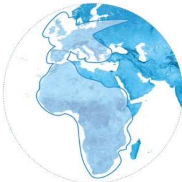
Рис. 38. Рабочие зоны ИСЗ HYLAS-4 (33,5° з.д.) в Ка-диапазоне частот
