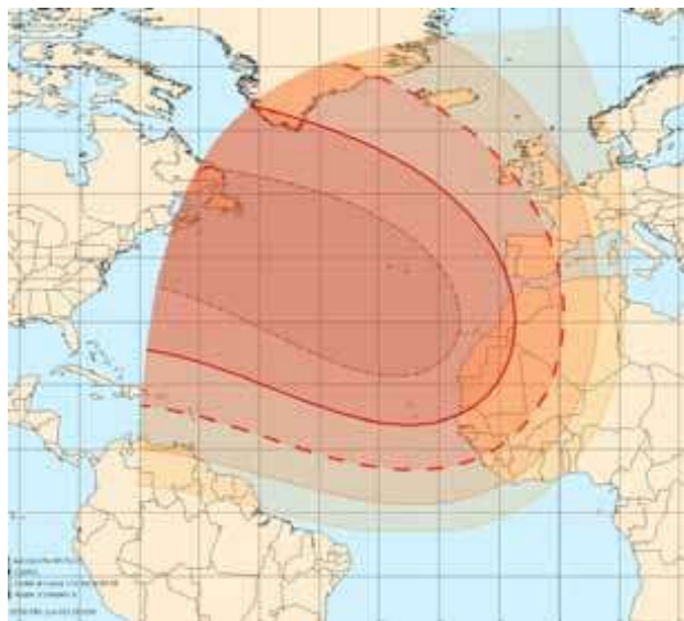
Рис. 25. Рабочие зоны на передачу (Северная Атлантика) ИСЗ серии SKYNET-5 в X-диапазоне частот
