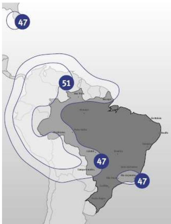
Рис. 17. ЭИИМ (дБ·Вт) в рабочих зонах (Анды) ИСЗ STAR ONE-C3 (75° з.д.) в Ки-диапазоне частот
