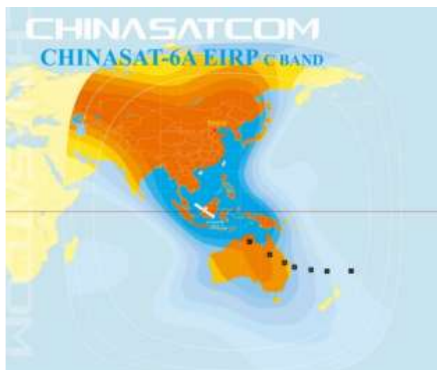
Рис. 4. ЭИИМ (дБ·Вт) в рабочих зонах ИСЗ CHINASAT-6A (125° в.д.) в C-диапазоне частот
