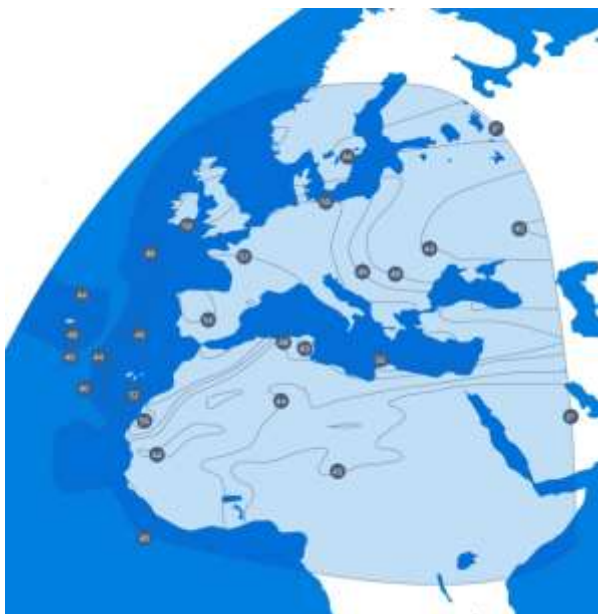
Рис. 21. ЭИИМ (дБ·Вт) в рабочих зонах ИСЗ HISPASAT-30W-6 (-1F) (30° з.д.) в С-диапазоне частот
