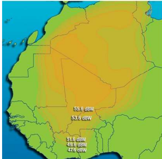
Рис. 81. ЭИИМ (дБ·Вт) в рабочих зонах (а – Атлантика и б – западная Африка) ИСЗ INTELSAT-25 (31,5° з.д.) в Ku-диапазоне частот
