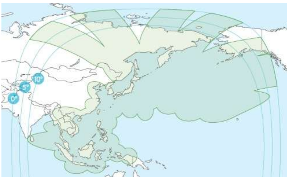
Рис. 22. Рабочие зоны ИСЗ JCSAT-18 (150° в.д.) в Ku-диапазоне частот
