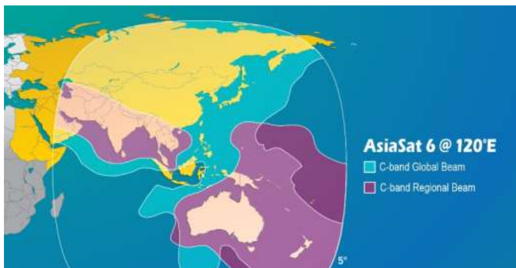
Рис. 27. Рабочие зоны ИСЗ ASIAsat-6/THAIKOM-7 (120° в.д.) в С-диапазоне частот
