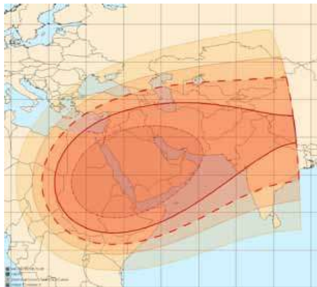
Рис. 24. Рабочие зоны на передачу (Западная Африка, Ближний и Средний Восток) ИСЗ серии SKYNET-5 в X-диапазоне частот
