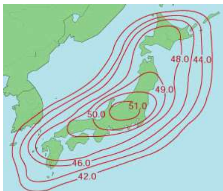
Рис. 2. ЭИИМ (дБ-Вт) в рабочей зоне ИСЗ JCSAT-4A (124° в.д.) в Ки-диапазоне частот
