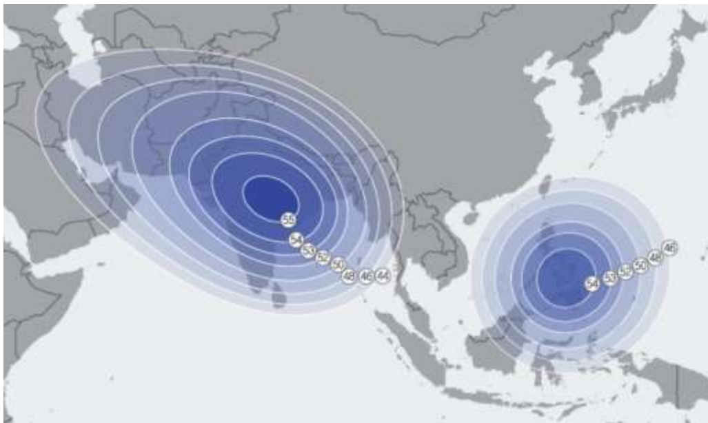
Рис. 15. ЭИИМ (дБ-Вт) в рабочих зонах (перенацеливаемые лучи) ИСЗ KOREASAT-5A (113° в.д.) в Ки-диапазоне частот
