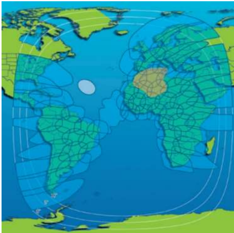
Рис. 127. Рабочие зоны (а – узкий луч, б – многолучевая диаграмма направленности) ИСЗ INTELSAT-37e (18° з.д.) в Ки-диапазоне частот
