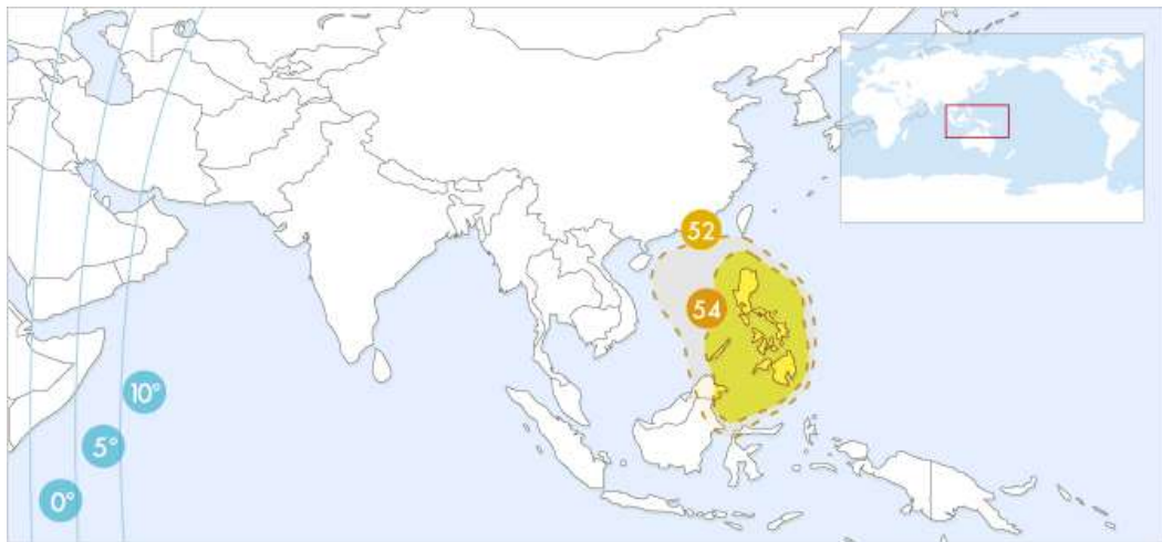
Рис. 18. ЭИИМ (дБ·Вт) в рабочих зонах (а - луч на Японию, б – луч на Юго-Восточную Азию, в – варианты перенацеливаемого луча) ИСЗ JCSAT-13 (124° в.д.) в Ки-диапазоне частот
