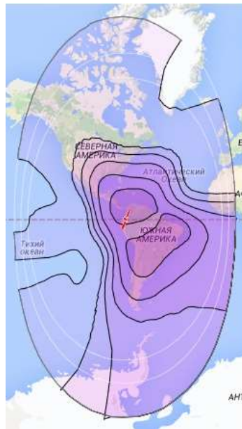
Рис. 3. Рабочие зоны ИСЗ VENESAT-1 (78° з.д.) в С-диапазоне частот
