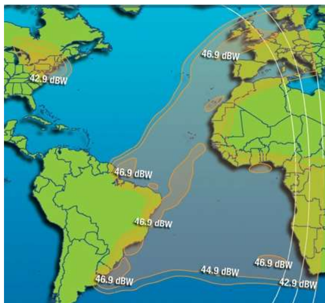
Рис. 107. ЭИИМ (дБ·Вт) в рабочих зонах (подвижные абоненты) ИСЗ INTELSAT-21 (58° з.д.) в Ку-диапазоне частот
