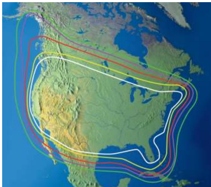
Рис. 58. ЭИИМ (дБ·Вт) в рабочих зонах (12 узких лучей) ИСЗ TELSTAR-18 VANTAGE/APSTAR-5C (138° з.д.) в Ки-диапазоне частот
