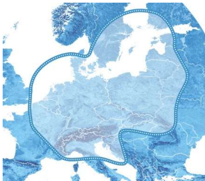
Рис. 37. Рабочие зоны ИСЗ HYLAS-2B (HYLAS-2, 31° в.д.) в Ка-диапазоне частот
