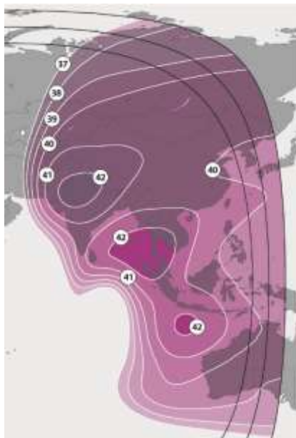
Рис. 57. ЭИИМ (дБ Вт) в рабочих зонах (восточный полуглобальный луч) ИСЗ NSS-12 (57° в.д.) в С-диапазоне частот
