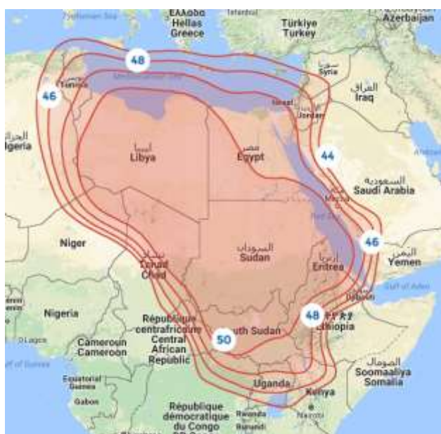
Рис. 14. ЭИИМ (дБ·Вт) в рабочих зонах (Central MENA) ИСЗ ARABSAT-5A (30,5° в.д.) в Ku-диапазоне частот
