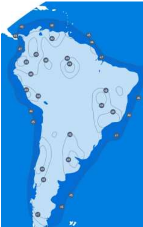
Рис. 9. ЭИИМ (дБ-Вт) в рабочих зонах (на Южную Америку) ИСЗ HISPASAT-74W-1 (AMAZONAS-4 (-4A)) (74° з.д.) в Ки-диапазоне частот
