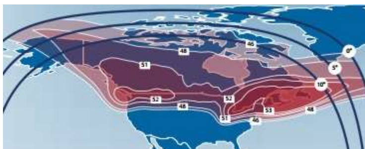
Рис. 48. ЭИИМ (дБ·Вт) в рабочих зонах ИСЗ АНИК-G1 (107,3° з.д.) в расширенном Ки-диапазоне частот
