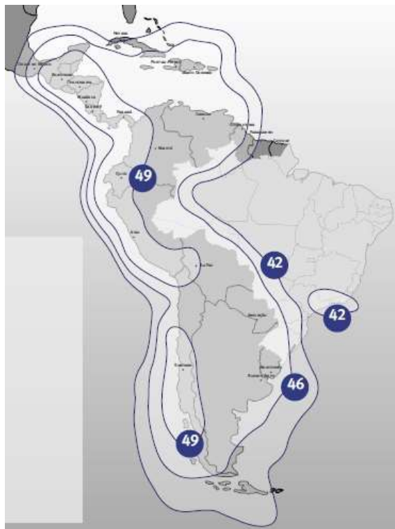
Рис. 21. ЭИИМ (дБ·Вт) в рабочих зонах (Латинская Америка) ИСЗ STAR ONE-S4 (70° з.д.) в Ки-диапазоне частот
