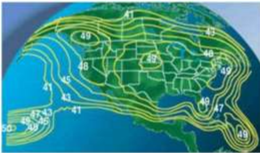
Рис. 66. ЭИИМ (дБ·Вт) в североамериканской рабочей зоне ИСЗ GALAXY-28 (INTELSAT-A8, 89° з.д.) в Ku-диапазоне частот
