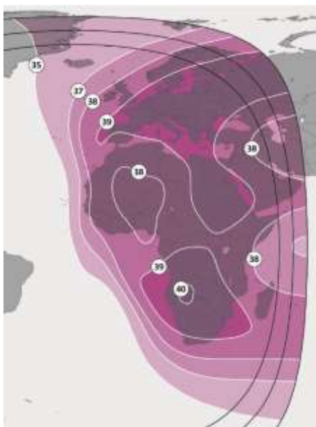
Рис. 14. ЭИИМ (дБВт) в рабочей зоне (восточный полуглобальный луч) ИСЗ NSS-7 (20° з.д.) в С-диапазоне частот
