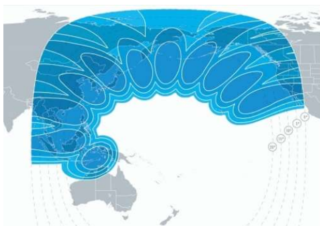
Рис. 78. ЭИИМ (дБ-Вт) в рабочих зонах (многолучевая диаграмма направленности) ИСЗ EUTESAT-172В (172° в.д.) в Ки-диапазоне частот
