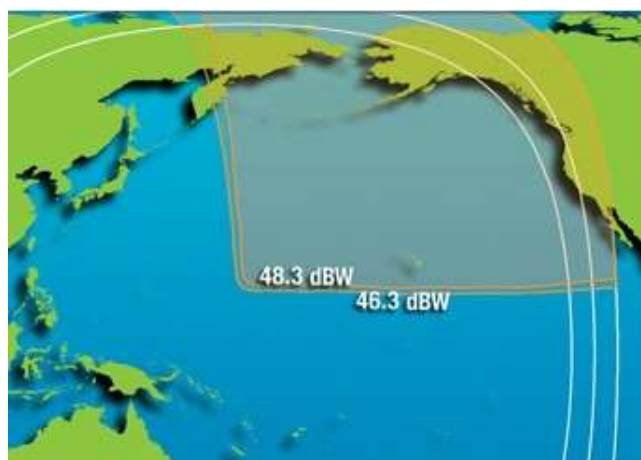
Рис. 99. ЭИИМ (дБ·Вт) в рабочих зонах (северо-восток Тихоокеанской зоны) ИСЗ INTELSAT-19 (166° в.д.) в Ku-диапазоне частот
