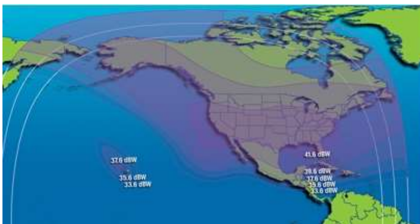
Рис. 55. ЭИИМ (дБ·Вт) в рабочих зонах (горизонтальная поляризация) ИСЗ GALAXY-12 (129° з.д.) в С-диапазоне частот
