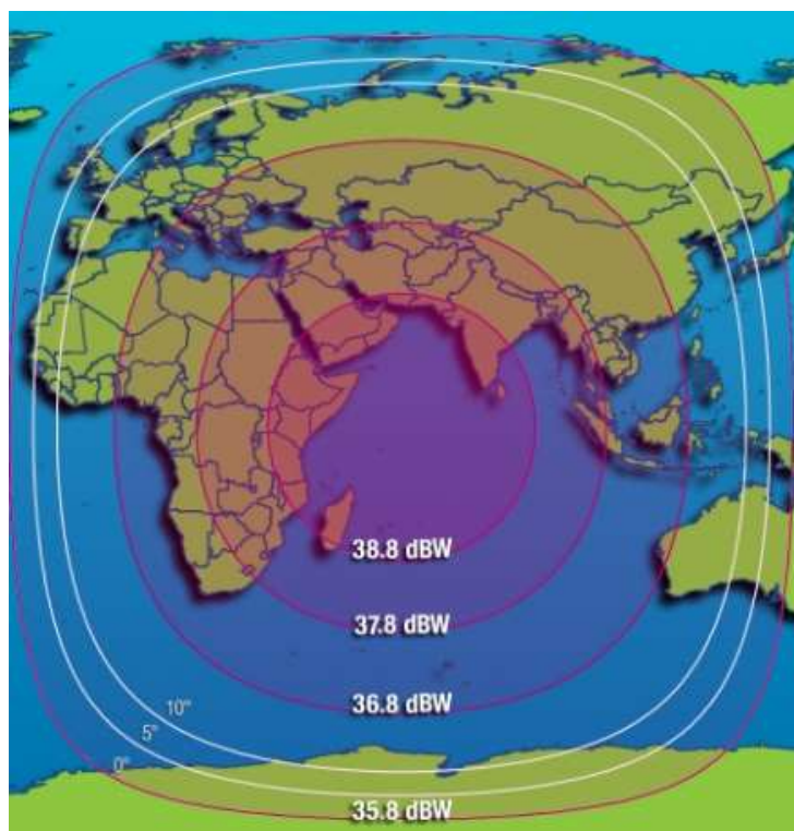
Рис. 119. ЭИИМ (дБ·Вт) в рабочих зонах (полуглобальный луч) ИСЗ INTELSAT-33e (60° в.д.) в Ka-диапазоне частот
