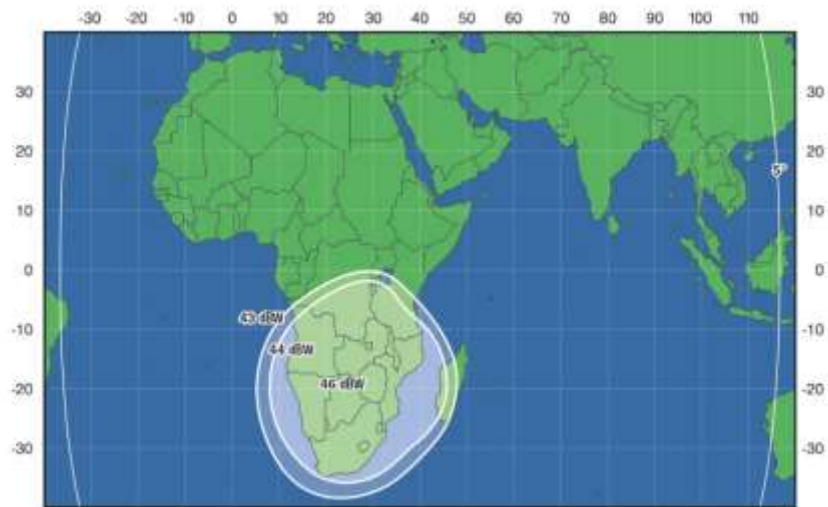
Рис. 39. ЭИИМ (дБ·Вт) в рабочей зоне (2 вариант перенацеливаемого луча) ИСЗ ЭКСПРЕСС-АМ7 (40° в.д.) в С-диапазоне частот
