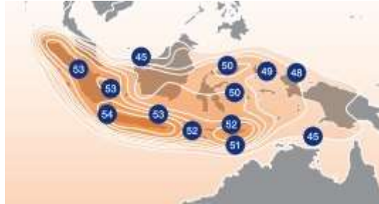
Рис. 14. ЭИИМ (дБ·Вт) в рабочих зонах ИСЗ MEASAT-3A (91,5° в.д.) в С- (а – полуглобальный луч) и Ku- (б – малазийский и в – индонезийский лучи) диапазонах частот
