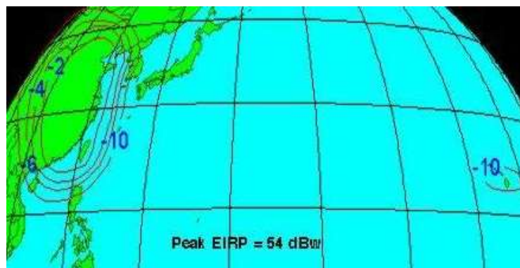
Рис. 6. ЭИИМ (дБ·Вт) в рабочих зонах (Восточная Азия и Гавайские о-ва, максимальная ЭИИМ 54 дБ·Вт) ИСЗ ORTUS-C1 (156° в.д.) в Ku-диапазоне частот
