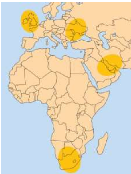
Рис. 16. Рабочие зоны перенацеливаемых лучей (на Ближний Восток, Европу и Африку) ИСЗ AMOS-17 (17° в.д.) в Ka-диапазоне частот
