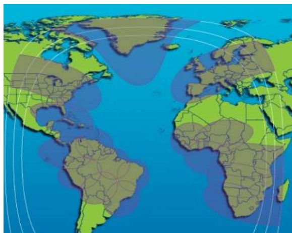
Рис. 121. ЭИИМ (дБ·Вт) в рабочих зонах (узкие лучи) ИСЗ INTELSAT-35е (34,5° з.д.) в С-диапазоне частот
