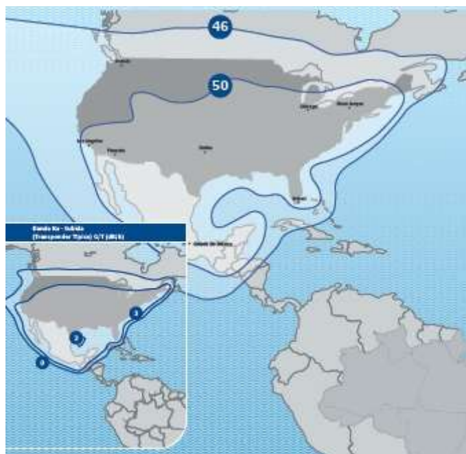
Рис. 22. ЭИИМ (дБ·Вт) в рабочих зонах (Северная Америка) ИСЗ STAR ONE-S4 (70° з.д.) в Ки-диапазоне частот
