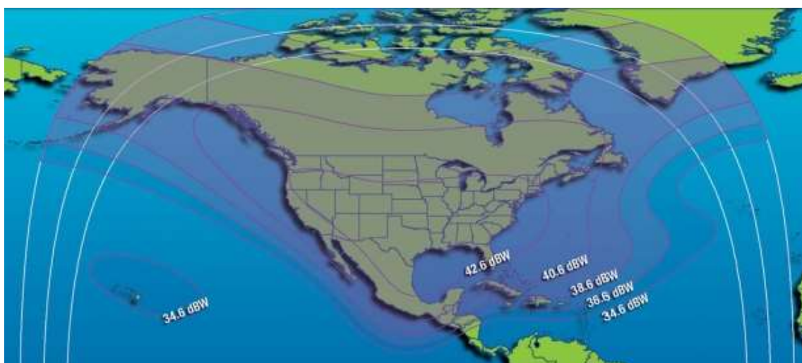
Рис. 72. ЭИИМ (дБ·Вт) в рабочих зонах ИСЗ GALAXY-15 (133° з.д.) в С-диапазоне частот
