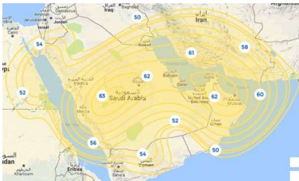
Рис. 17. ЭИИМ (дБ·Вт) в рабочих зонах ИСЗ ARABSAT-5A (30,5° в.д.) в Ка-диапазоне частот
