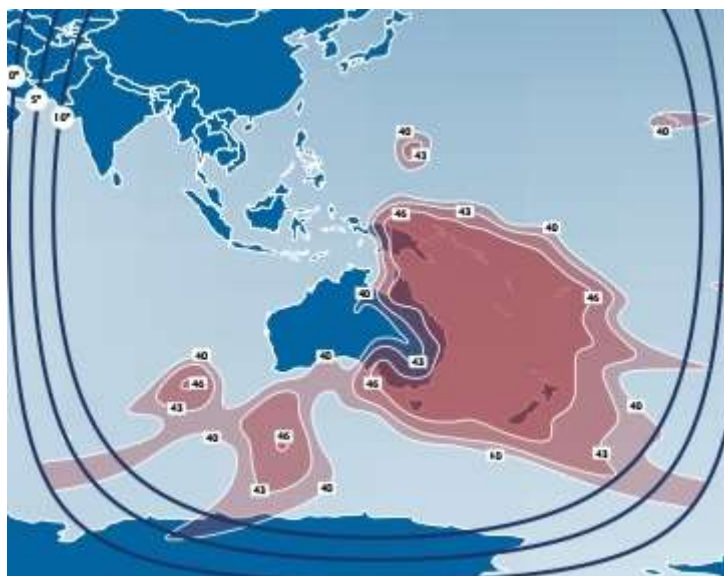
Рис. 22. ЭИИМ (дБ·Вт) в рабочих зонах ИСЗ APSTAR-5C/TELSTAR-18 VANTAGE (138° в.д.) в С-диапазоне частот
