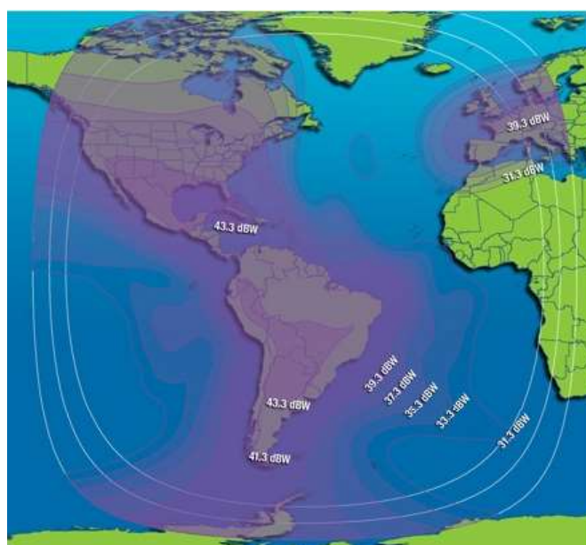
Рис. 105. ЭИИМ (дБ·Вт) в рабочих зонах ИСЗ INTELSAT-21 (58° з.д.) в С-диапазоне частот
