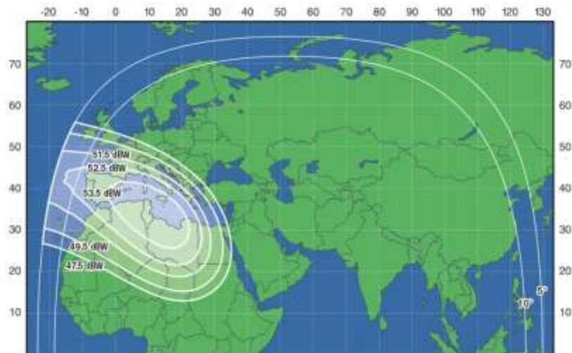
Рис. 34. ЭИИМ (дБ-Вт) в рабочей зоне (вариант 2-го перенацеливаемого луча) ИСЗ ЭКСПРЕСС-АМ6 (53° в.д.) в Ки-диапазоне частот
