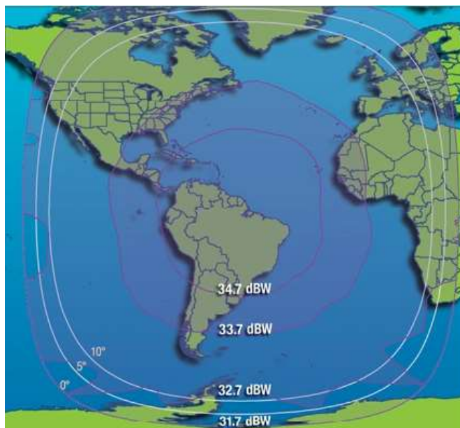
Рис. 108. ЭИИМ (дБ·Вт) в рабочих зонах (глобальный луч) ИСЗ INTELSAT-23 (53° з.д.) в С-диапазоне частот
