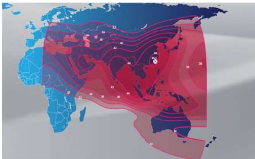
Рис. 30. Рабочие зоны (а) и ЭИИМ (дБ·Вт) в рабочих зонах (б) ИСЗ ST-2 (88° в.д.) в С-диапазоне частот
