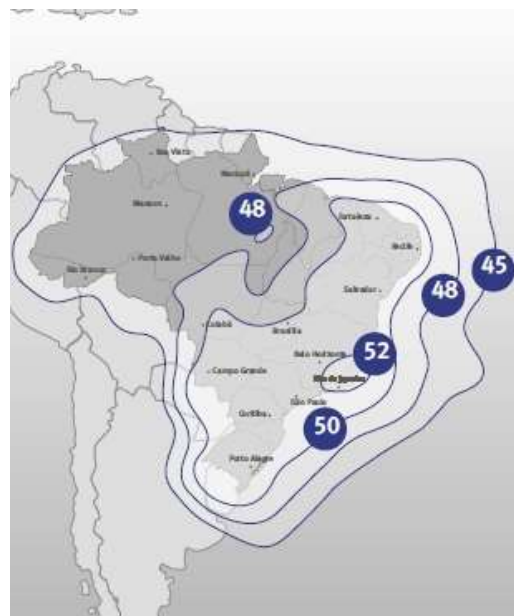
Рис. 11. ЭИИМ (дБ·Вт) в рабочих зонах (Бразилия) ИСЗ HISPASAT-74W-1 (STAR ONE-C4) (70° з.д.) в Ку-диапазоне частот
