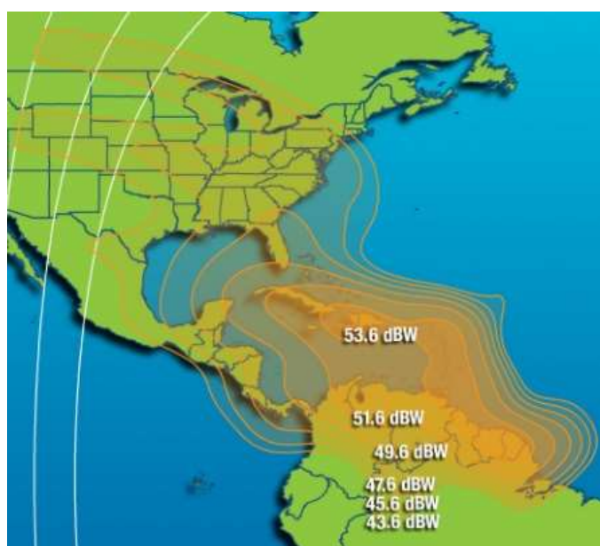
Рис. 123. ЭИИМ (дБ·Вт) в рабочих зонах (Карибские острова) ИСЗ INTELSAT-35е (34,5° з.д.) в Ku-диапазоне частот
