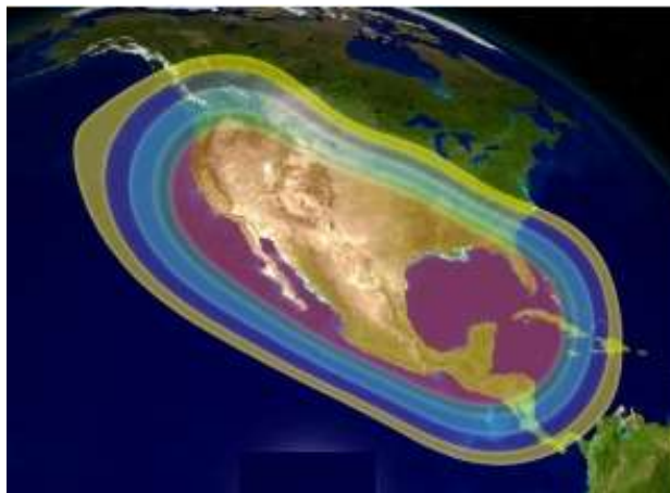
Рис. 1. Рабочие зоны ИСЗ МEXSAT-3 (114,8° з.д.) в С-диапазоне частот
