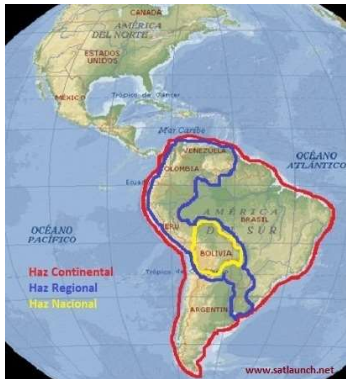
Рис. 1. Рабочие зоны ИСЗ TUPAC KATARI-1 (87,2° з.д.) в С-, Ku- и Ka-диапазонах частот
