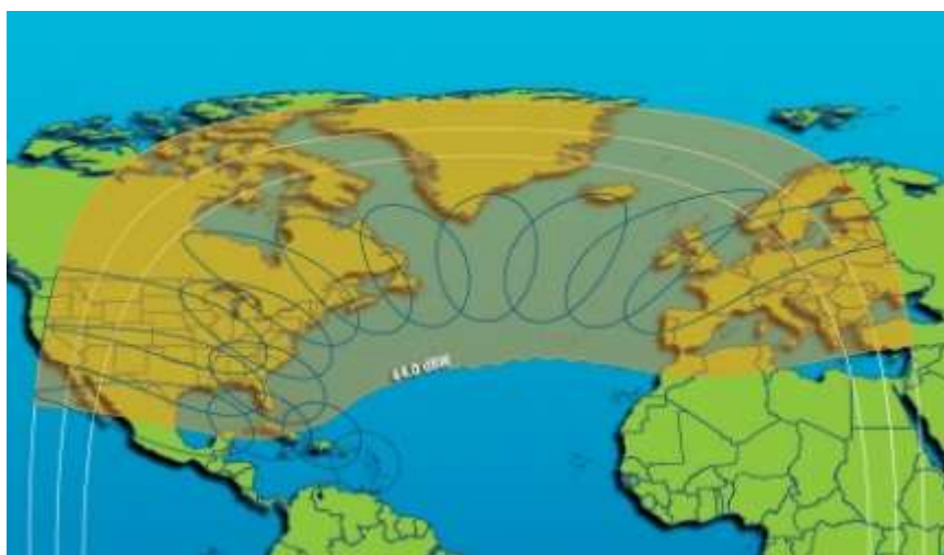
Рис. 120. ЭИИМ (дБ·Вт) в рабочих зонах (многолучевая) ИСЗ INTELSAT-32e (43,1° з.д.) в Ku-диапазоне частот
