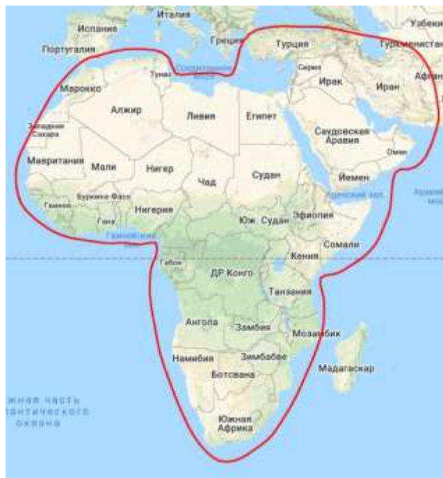
Рис. 38. Рабочие зоны ИСЗ ARABSAT-6A (30,5° в.д.) в Ка-диапазоне частот
