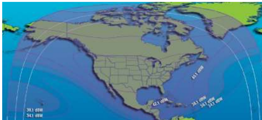
Рис. 81. ЭИИМ (дБ·Вт) в рабочих зонах (а – Атлантика и б – западная Африка) ИСЗ INTELSAT-25 (31,5° з.д.) в Ku-диапазоне частот
