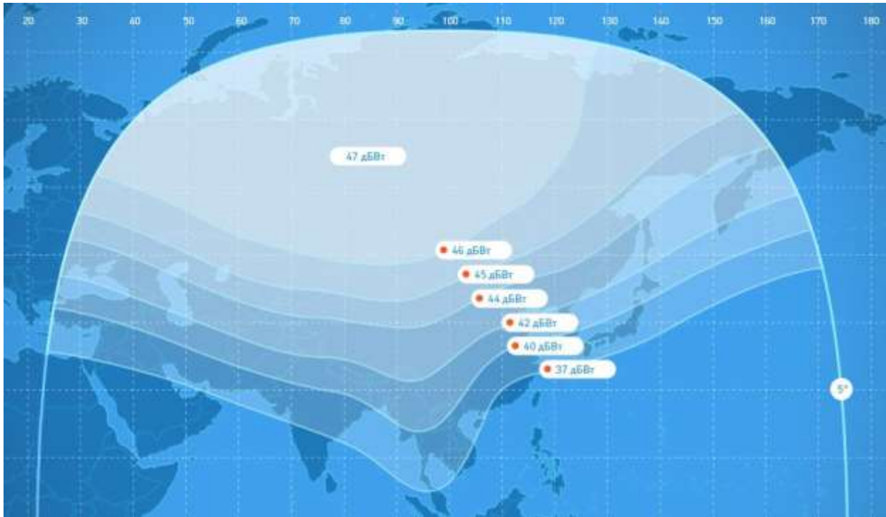
Рис. 3. ЭИИМ (дБВт) в рабочей зоне (фиксированный луч) ИСЗ ЭКСПРЕСС-АМЗ (103° в.д.) в С-диапазоне частот
