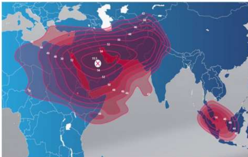
Рис. 34. ЭИИМ (дБ·Вт) в рабочих зонах (Ближний Восток и часть Индонезии) ИСЗ ST-2 (88° в.д.) в Ku-диапазоне частот
