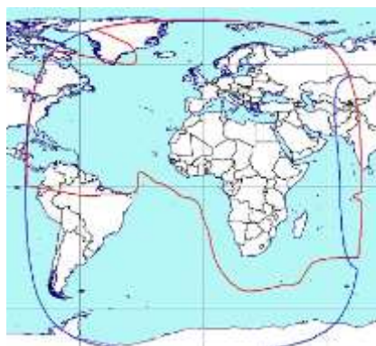
Рис. 10. Рабочие зоны (а) и ЭИИМ (дБ·Вт) в рабочих зонах (б) ИСЗ ATLANTIC BIRD-3 (5° з.д.) в С-диапазоне частот
