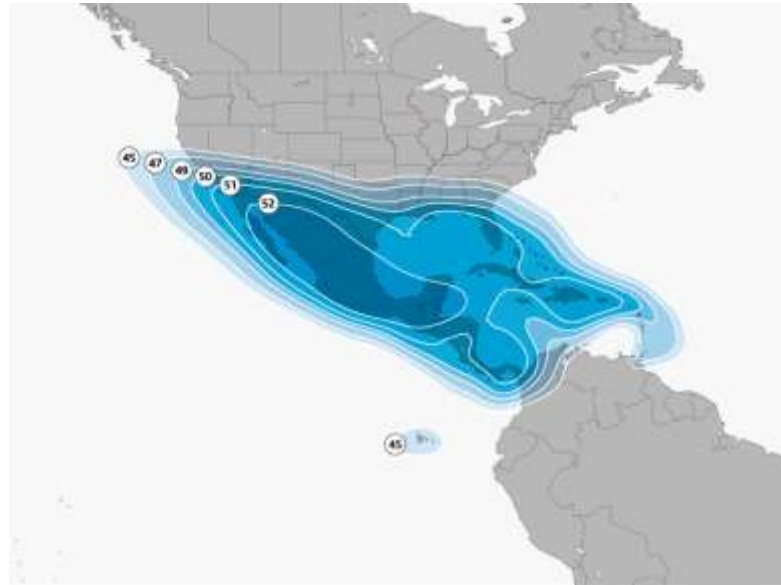
Рис. 121. ЭИИМ (дБ Вт) в рабочих зонах (Мексика и страны Карибского бассейна) ИСЗ SES-10 (67° з.д.) в Ки-диапазоне частот
