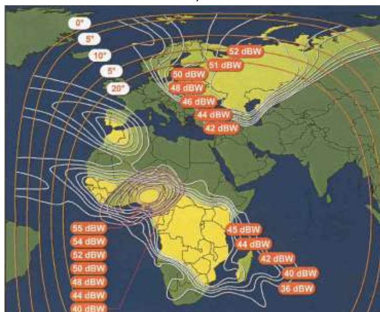
Рис. 3. ЭИИМ (дБ·Вт) в рабочих зонах (а – Россия, б - Россия и Африка) ИСЗ EUTELSAT-W4 (36° в.д.) в Ки-диапазоне частот
