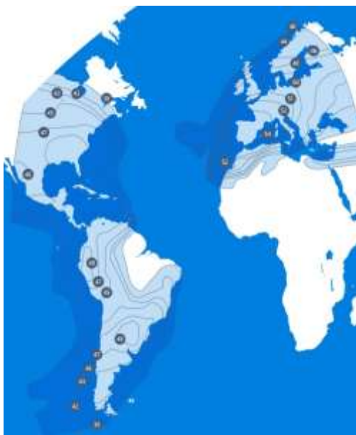
Рис. 2. Рабочие зоны и ЭИИМ (дБ-Вт) в рабочих зонах ИСЗ HISPASAT-30W-4 (-1D) (30° з.д.) в Ки-диапазоне частот
