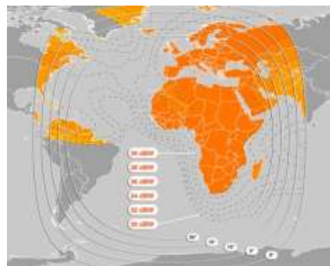
Рис. 10. Рабочие зоны (а) и ЭИИМ (дБ·Вт) в рабочих зонах (б) ИСЗ ATLANTIC BIRD-3 (5° з.д.) в С-диапазоне частот
