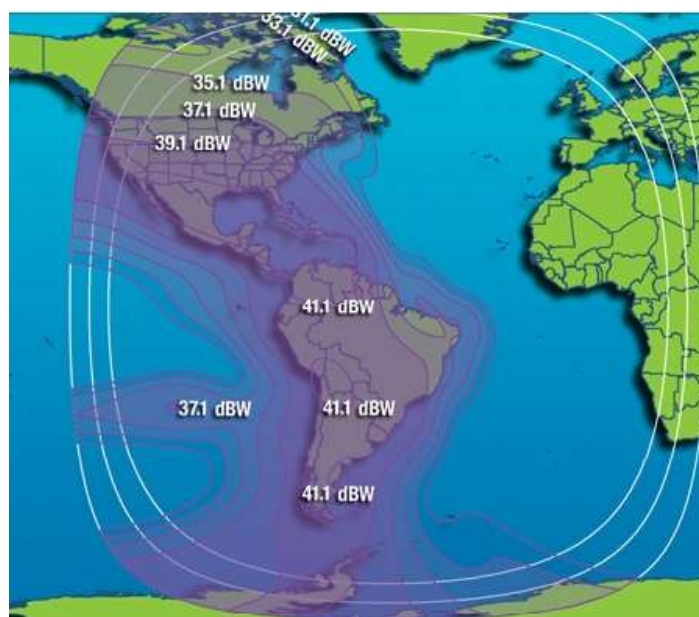
Рис. 109. ЭИИМ (дБ·Вт) в рабочих зонах (западный полуглобальный луч) ИСЗ INTELSAT-23 (53° з.д.) в С-диапазоне частот
