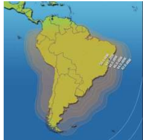
Рис. 65. ЭИИМ (дБ·Вт) в южноамериканской рабочей зоне ИСЗ GALAXY-28 (INTELSAT-A8, 89° з.д.) в Ku-диапазоне частот
