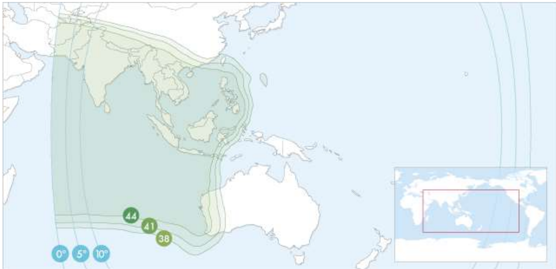
Рис. 15. ЭИИМ (дБ·Вт) в рабочих зонах (юго-восточная Азия) ИСЗ SUPERBIRD-7 (144° в.д.) в Ки-диапазоне частот
