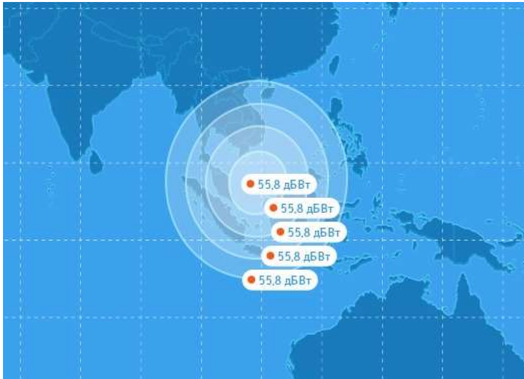
Рис. 5. ЭИИМ (дБВт) в рабочей зоне (перенацеливаемый луч) ИСЗ ЭКСПРЕСС-АМЗ (103° в.д.) в Ки-диапазоне частот
