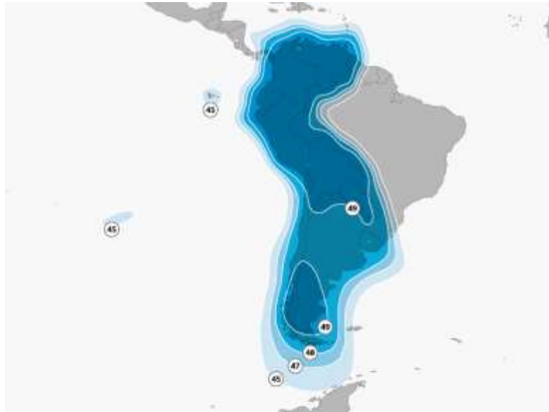
Рис. 119. ЭИИМ (дБ Вт) в рабочих зонах (Южная Америка (без Бразилии)) ИСЗ SES-10 (67° з.д.) в Ки-диапазоне частот
