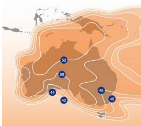
Рис. 16. ЭИИМ (дБ·Вт) в рабочих зонах (а – индийский, б – индонезийский, в - малазийский и г – австралийский лучи) ИСЗ MEASAT-3B (91,5° в.д.) в Ки- диапазоне частот
