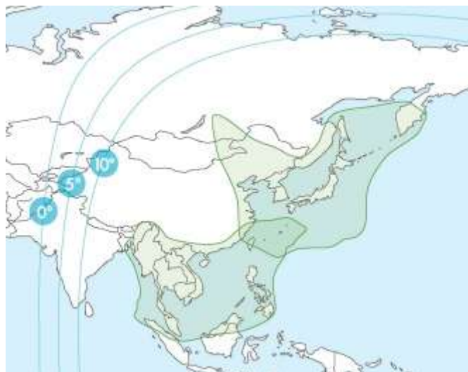
Рис. 23. Рабочие зоны ИСЗ JCSAT-18 (150° в.д.) в Ku-диапазоне частот
