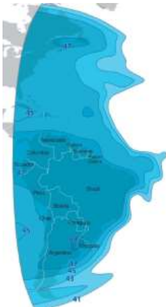
Рис. 59. ЭИИМ (дБ·Вт) в рабочих зонах ИСЗ ABS-3A (3° з.д.) в С-диапазоне частот
