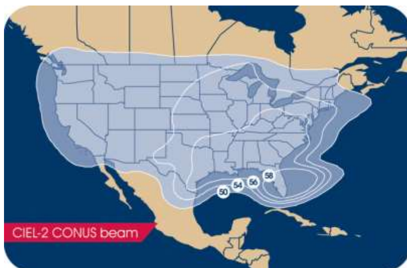
Рис. 104. ЭИИМ (дБ·Вт) в рабочей зоне на США ИСЗ CIEL-2 (129° з.д.) в Ки-диапазоне частот
