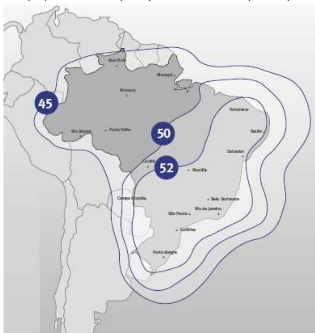
Рис. 18. ЭИИМ (дБ·Вт) в рабочих зонах (Бразилия) ИСЗ STAR ONE-C3 (75° з.д.) в Ки-диапазоне частот
