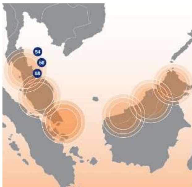
Рис. 12. ЭИИМ (дБ·Вт) в рабочих зонах ИСЗ MEASAT-5 (119,5° в.д.) в Ки-диапазоне частот
