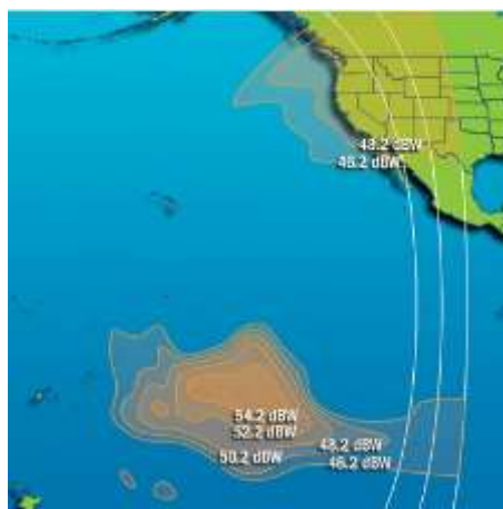
Рис. 93. ЭИИМ (дБ·Вт) в рабочих зонах (а – австралийский луч, б – полинезийский луч) ИСЗ INTELSAT-18 (180° в.д.) в Ки-диапазоне частот
