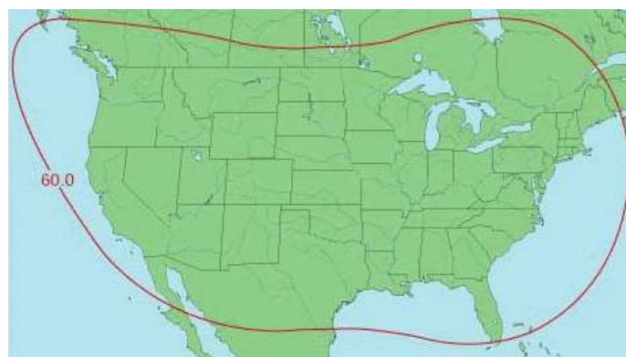
Рис. 2. ЭИИМ (дБ·Вт) в рабочей зоне ИСЗ серии SIRIUS CD RADIO
