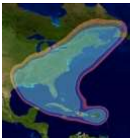
Рис. 94. Рабочие зоны ИСЗ HORIZONS-2 (74° з.д.) в Ки-диапазоне частот
