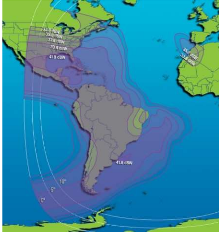
Рис. 10. ЭИИМ (дБВт) в рабочих зонах ИСЗ INTELSAT-9 (PAS-9, 29,5° з.д.) в С-диапазоне частот
