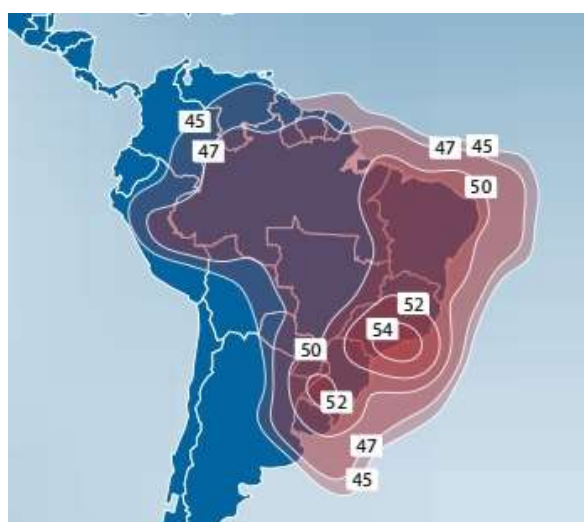
Рис. 53. ЭИИМ (дБ·Вт) в рабочих зонах (два зональных луча) ИСЗ TELSTAR-19 VANTAGE (63° з.д.) в Ки-диапазоне частот
