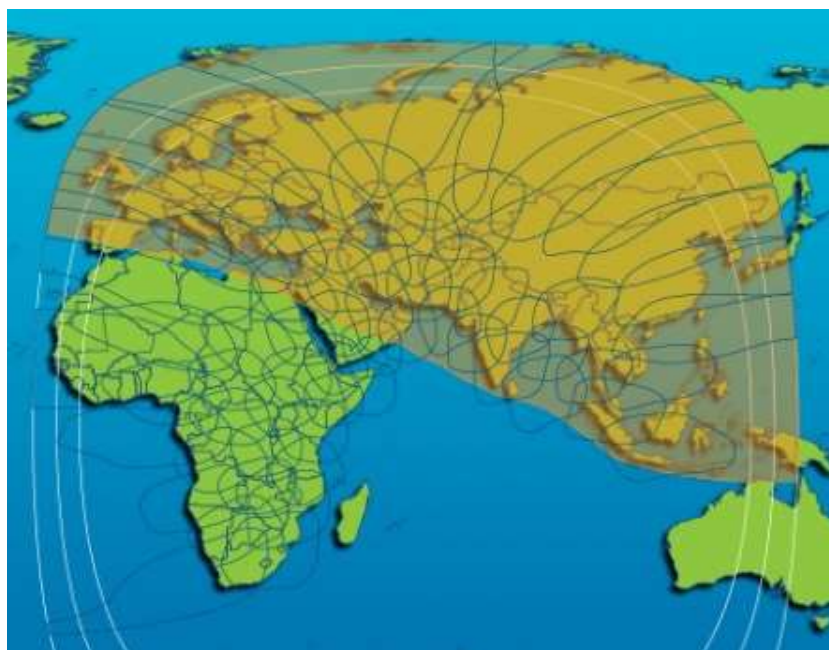
Рис. 118. ЭИИМ (дБ·Вт) в рабочих зонах (многолучевая) ИСЗ INTELSAT-33e (60° в.д.) в Ku-диапазоне частот
