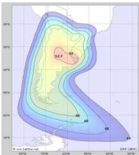
Рис. 106. ЭИИМ (дБ·Вт) в рабочей зоне ИСЗ ARSAT-1 (71,8° з.д.) в Ки-диапазоне частот
