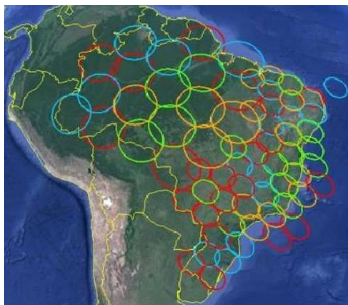
Рис. 2. Рабочие зоны ИСЗ SGDC-1 (75° з.д.) в Ka-диапазоне частот
