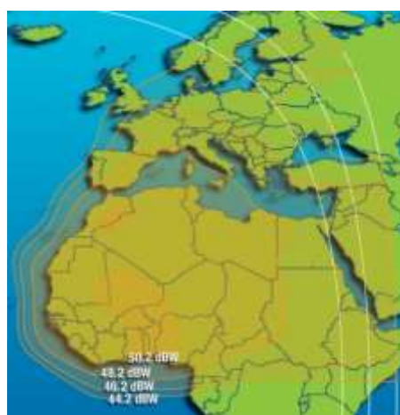
Рис. 122. ЭИИМ (дБ·Вт) в рабочих зонах (Африка и Европа) ИСЗ INTELSAT-35е (34,5° з.д.) в Ku-диапазоне частот
