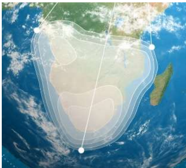
Рис. 34. Рабочие зоны (а – FSS, б – BSS, в – ME, г – SA) ИСЗ HELLAS-SAT-3 (39° в.д.) в Ku-диапазоне частот
