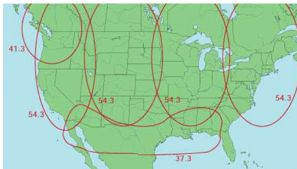
Рис. 10. ЭИИМ (дБ·Вт) в рабочих зонах ИСЗ AMSC (а) и TMI (б) в L-диапазоне частот
