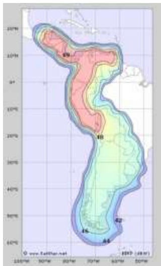
Рис. 33. ЭИИМ (дБ-Вт) в рабочих зонах (а – Бразилия и б – Латинская Америка) ИСЗ AMAZONAS-5 (61° з.д.) в Ки-диапазоне частот
