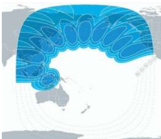
Рис. 20. ЭИИМ (дБ·Вт) в рабочих зонах (многолучевая диаграмма направленности на северо-восточную Азию и север Тихого океана) ИСЗ GE-23 (172° в.д.) в Ки-диапазоне частот
