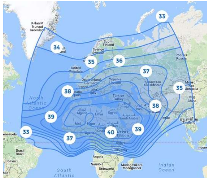
Рис. 7. ЭИИМ (дБ·Вт) в рабочих зонах (а – высокий и б – средний уровень мощности) ИСЗ ARABSAT-4AR (26° в.д.) в С-диапазоне частот
