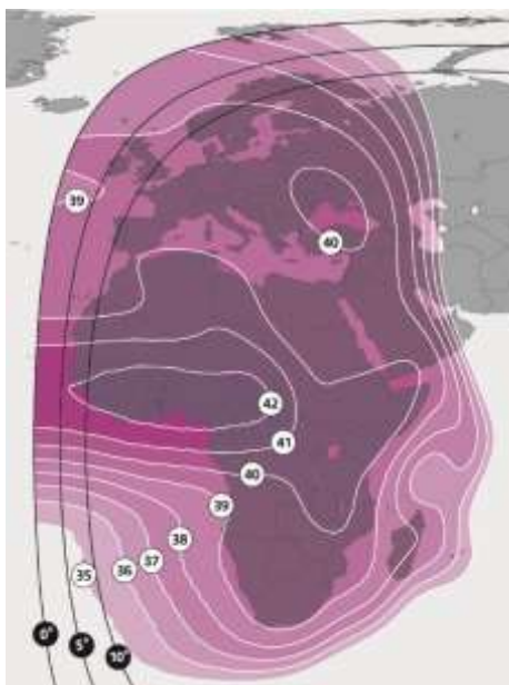
Рис. 56. ЭИИМ (дБ Вт) в рабочих зонах (западный полуглобальный луч) ИСЗ NSS-12 (57° в.д.) в С-диапазоне частот
