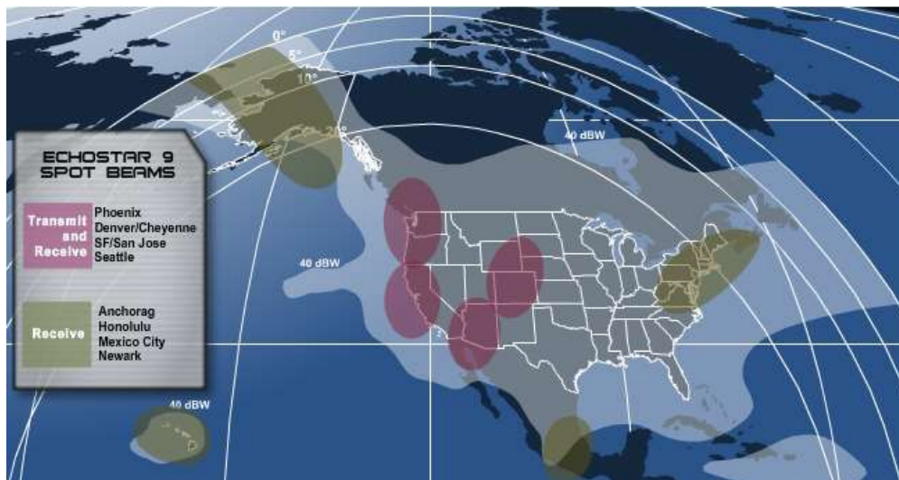
Рис. 76. ЭИИМ (дБ·Вт) в рабочей зоне ИСЗ ECHOSTAR-9 (121° з.д.) в Ки-диапазоне частот
