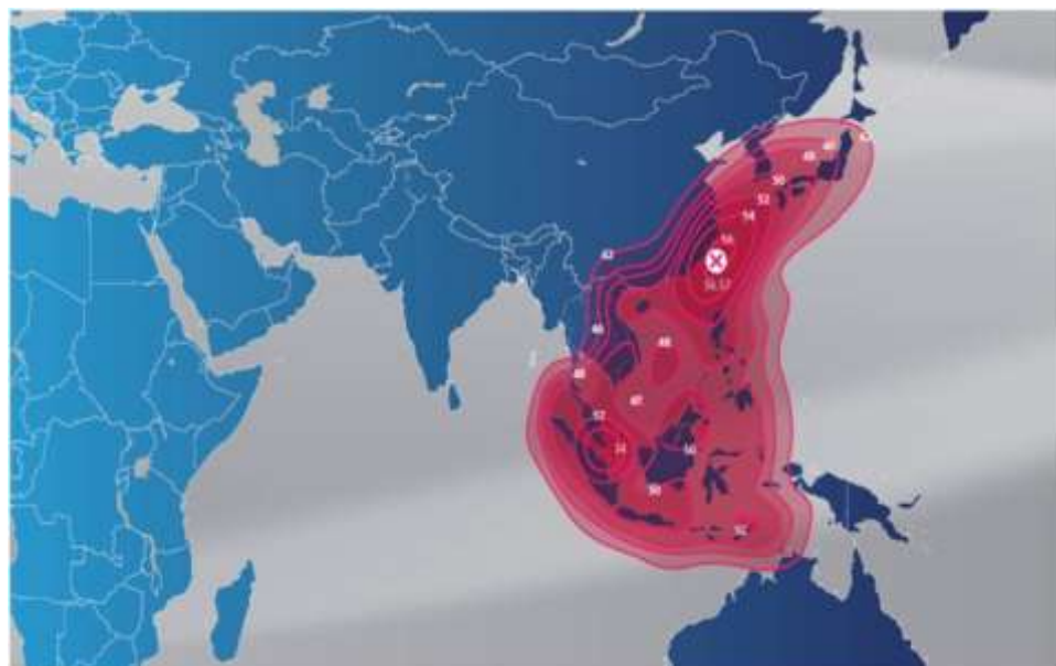
Рис. 32. ЭИИМ (дБ·Вт) в рабочих зонах (Юго-Восточная Азия) ИСЗ ST-2 (88° в.д.) в Ku-диапазоне частот
