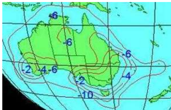
Рис. 4. ЭИИМ (дБ·Вт) в рабочих зонах (австралийский луч В, максимальная ЭИИМ 52 дБ·Вт) ИСЗ OPTUS-C1 (156° в.д.) в Ku-диапазоне частот
