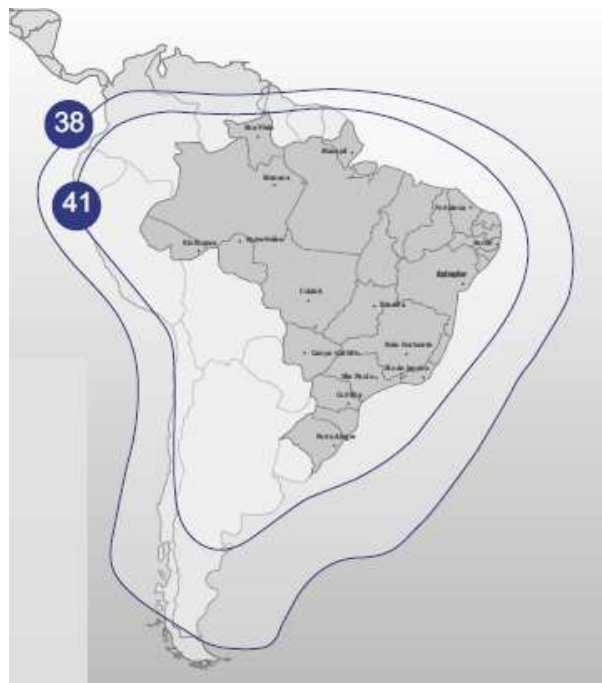
Рис. 16. ЭИИМ (дБ·Вт) в рабочей зоне (на Бразилию) ИСЗ STAR ONE-C3 (75° з.д.) в С-диапазоне частот
