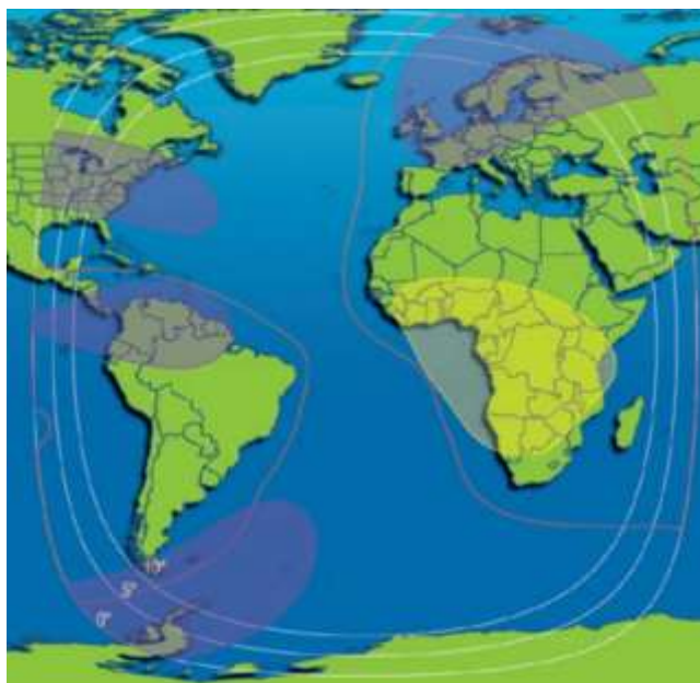
Рис. 125. Рабочие зоны ИСЗ INTELSAT-37e (18° з.д.) в C-диапазоне частот
