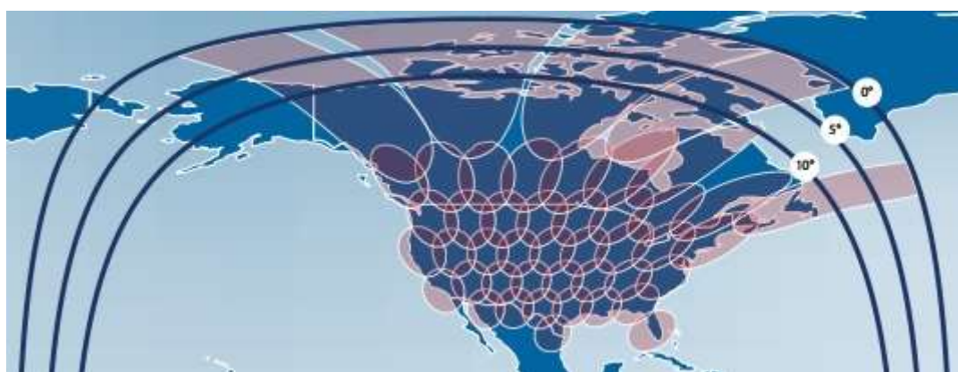
Рис. 32. ЭИИМ (дБ·Вт) в рабочей зоне (Северная Америка) ИСЗ ANIK-F2 (111,1° з.д.) в Ки-диапазоне частот
