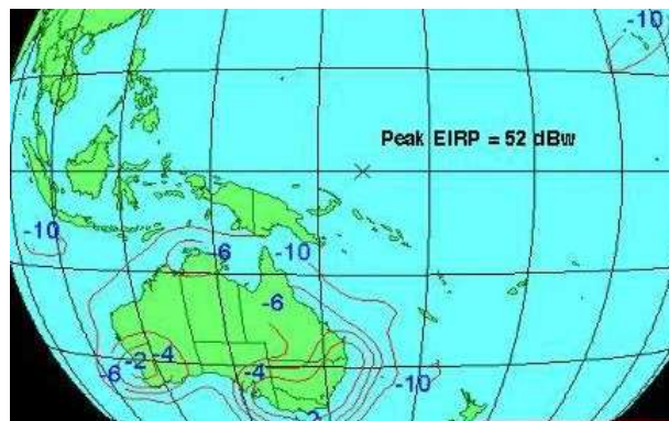
Рис. 3. ЭИИМ (дБ·Вт) в рабочих зонах (австралийский луч А, максимальная ЭИИМ 52 дБ·Вт) ИСЗ OPTUS-C1 (156° в.д.) в Ku-диапазоне частот
