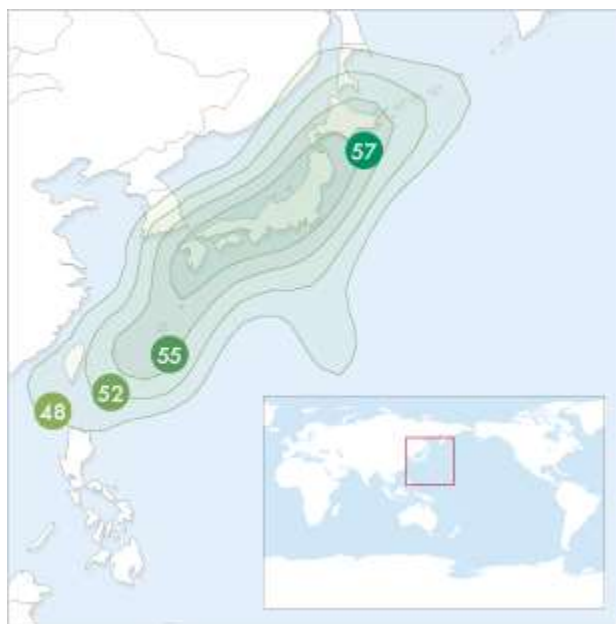
Рис. 4. ЭИИМ (дБ-Вт) в рабочей зоне ИСЗ JCSAT-2A (154° в.д.) в Ku-диапазоне частот
