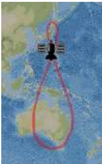
Рис. 6. Подспутниковая трасса ИСЗ МІСНІВІКІ-2 (QZS-2)
