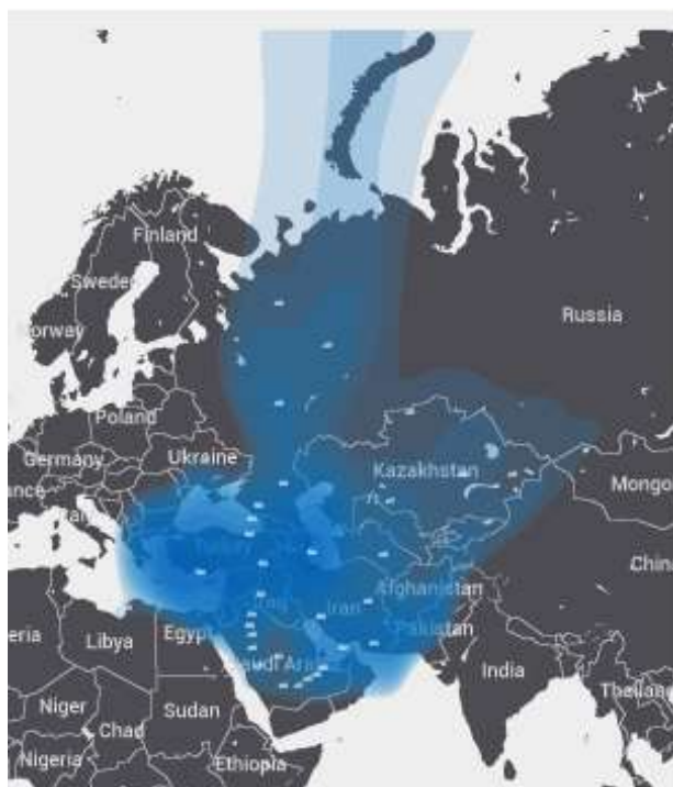
Рис. 3. ЭИИМ (дБ·Вт) в рабочих зонах (Центральная Азия) ИСЗ AFRICASAT-1A/AZERSPACE-1 (46° в.д.) в Ку-диапазоне частот
