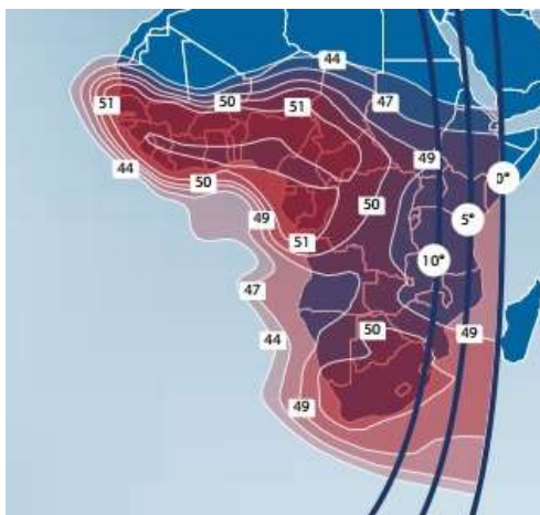
Рис. 41. Рабочие зоны (а) и ЭИИМ (дБ·Вт) в рабочих зонах (б) ИСЗ TELSTAR-11N (37,5° з.д.) в Ки-диапазоне частот
