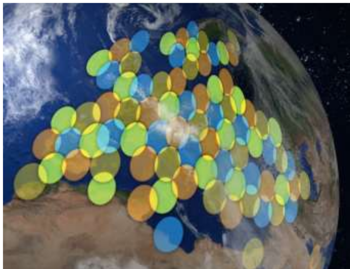
Рис. 38. Расположение наземных зон многолучевой антенны ИСЗ KA-SAT (9° в.д.) в Ка-диапазоне частот
