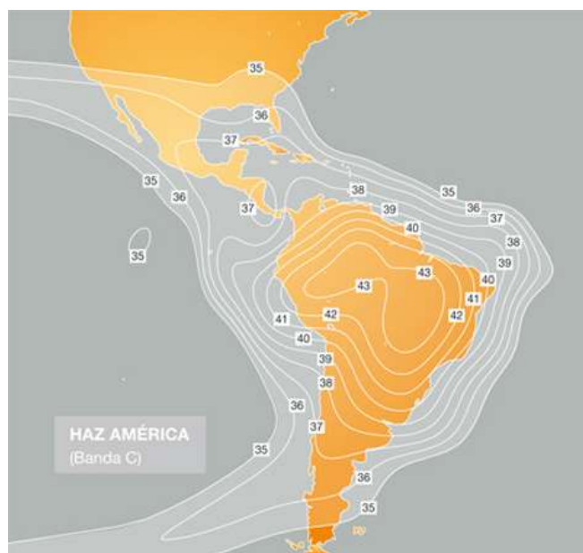
Рис. 27. ЭИИМ (дБ-Вт) в рабочей зоне (на Южную и Центральную Америку) ИСЗ AMAZONAS-3 (61° з.д.) в С-диапазоне частот
