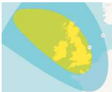
Рис. 72. ЭИИМ (дБ Вт) в рабочей зоне (Великобритания) ИСЗ ASTRA-1N (28,2° в.д.) в Ku-диапазоне частот
