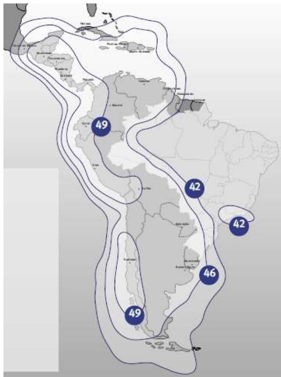
Рис. 12. ЭИИМ (дБ·Вт) в рабочих зонах (Латинская Америка) ИСЗ HISPASAT-74W-1 (STAR ONE-C4) (70° з.д.) в Ku-диапазоне частот
