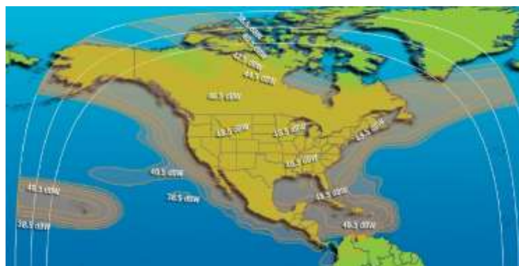
Рис. 82. ЭИИМ (дБ·Вт) в рабочих зонах ИСЗ GALAXY-19 (97° з.д.) в С- (а) и Ku- (б) диапазонах частот
