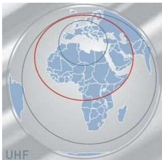
Рис. 1. Рабочие зоны ИСЗ SICRAL-1В (11,8° в.д.) в UHF-диапазоне частот
