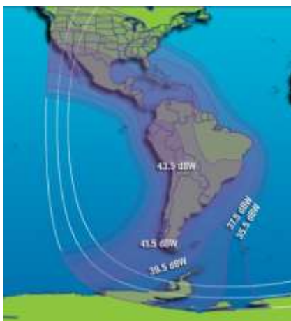
Рис. 85. ЭИИМ (дБ·Вт) в рабочих зонах ИСЗ INTELSAT-14 (45° з.д.) в С-диапазоне частот
