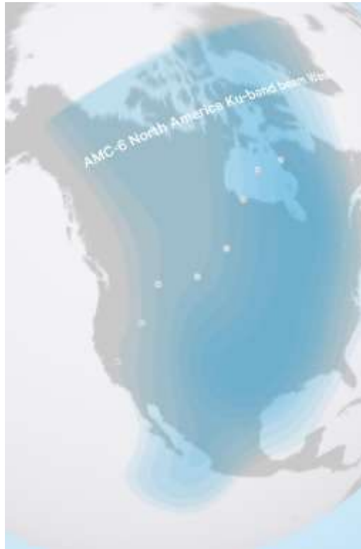
Рис. 10. ЭИИМ (дБ Вт) в рабочих зонах ИСЗ AMC-6 (GE-6, а и б – 67° з.д., в и г – 83° з.д., д и е – 139° з.д.) в Ku-диапазоне частот
