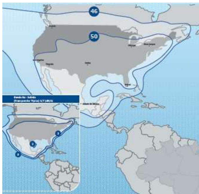
Рис. 13. ЭИИМ (дБ·Вт) в рабочих зонах (Северная Америка) ИСЗ HISPASAT-74W-1 (STAR ONE-C4) (70° з.д.) в Ku-диапазоне частот
