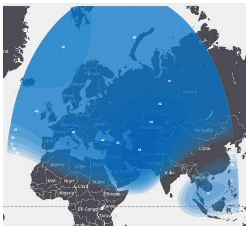
Рис. 2. ЭИИМ (дБ·Вт) в рабочих зонах (Центральная Азия и Европа) ИСЗ AFRICASAT-1/AZERSPACE-1 (46° в.д.) в С-диапазоне частот
