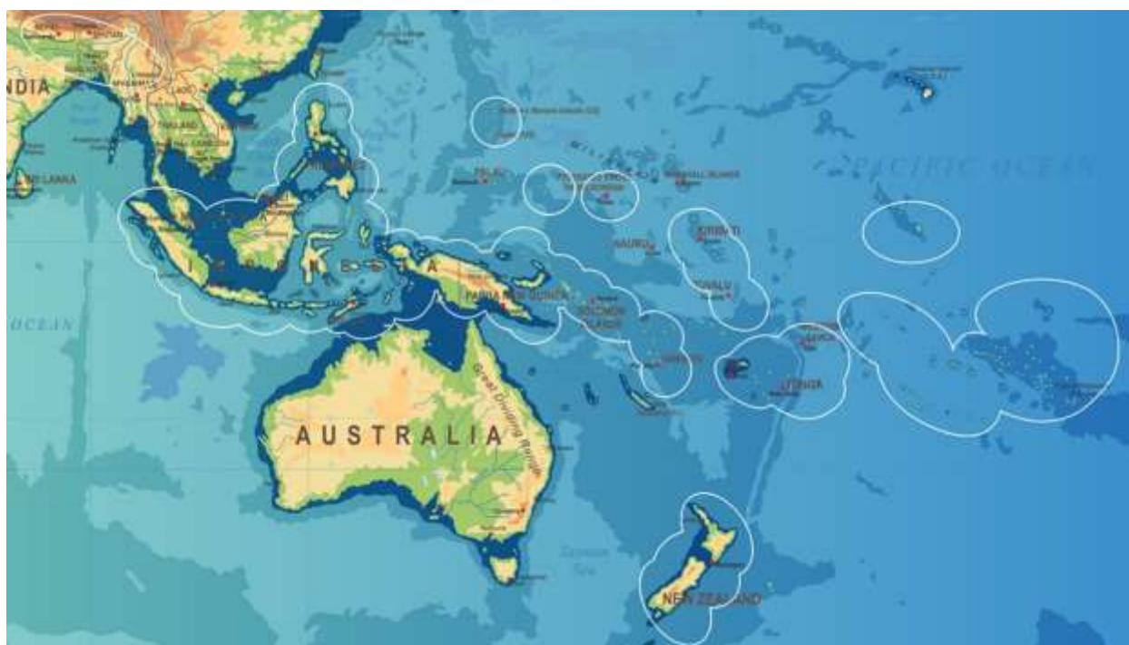
Рис. 24. Рабочие зоны ИСЗ JCSAT-18 (150° в.д.) в Ka-диапазоне частот
