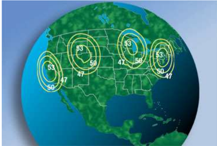
Рис. 68. ЭИИМ (дБ-Вт) в рабочих зонах ИСЗ GALAXY-28 (INTELSAT-A8, 89° з.д.) в Ка-диапазоне частот
