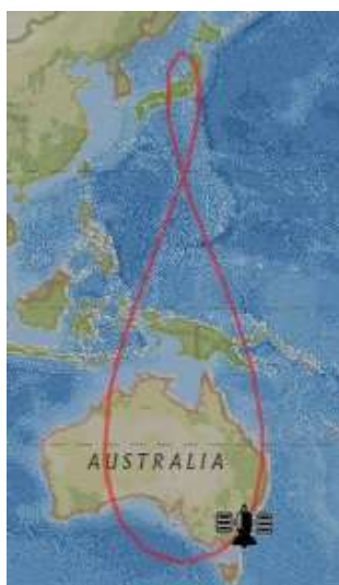
Рис. 6. Подспутниковая трасса ИСЗ МІСНІВІКІ-2 (QZS-2)
