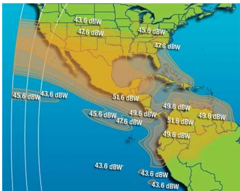
Рис. 111. ЭИИМ (дБ·Вт) в рабочих зонах (юг США, Центральная Америка и северная часть Латинской Америки) ИСЗ INTELSAT-23 (53° з.д.) в Ku-диапазоне частот
