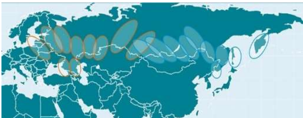
Рис. 77. Рабочие зоны ИСЗ ЭКСПРЕСС-АМ6 (53° в.д.) и ЭКСПРЕСС-АМ5 (140° в.д.) в Ка-диапазоне частот
