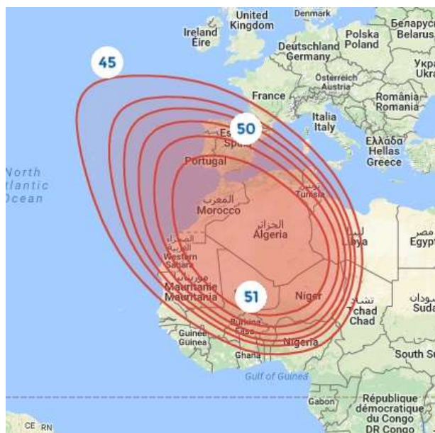
Рис. 22. ЭИИМ (дБ·Вт) в рабочих зонах (BSS West Africa) ИСЗ ARABSAT-5B (26° в.д.) в Ku-диапазоне частот
