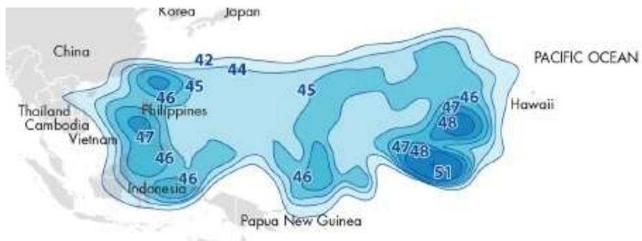
Рис. 45. ЭИИМ (дБ Вт) в рабочих зонах (8 ретрансляторов с полосами частот по 27 МГц, горизонтальная поляризация, южный луч) ИСЗ ABS-6 (ABS-1, LMI-1) (159° в.д.) в Ku-диапазоне частот
