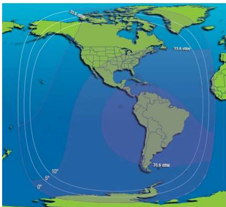
Рис. 113. ЭИИМ (дБ·Вт) в рабочих зонах (полуглобальный луч) ИСЗ INTELSAT-30 (95° з.д.) в S-диапазоне частот
