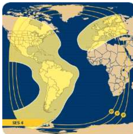
Рис. 88. Рабочие зоны ИСЗ SES-6 (40,5° з.д.) в С-диапазоне частот
