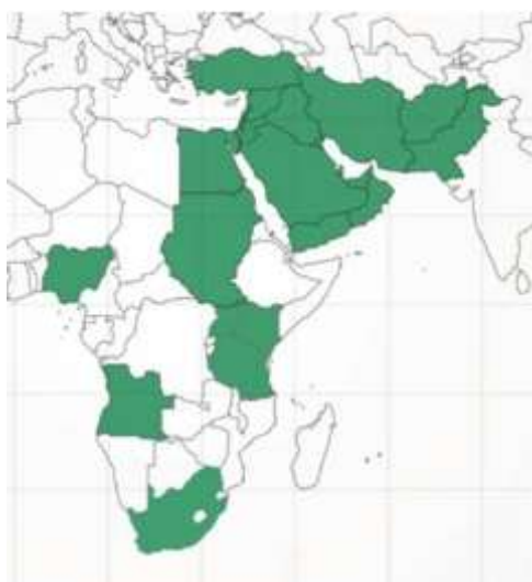
Рис. 7. Рабочие зоны (а – первоначальная, б - расширенная) ИСЗ YAHSAT-1B (47,5° в.д.) в Ka-диапазоне частот (услуга YahClick или YahCarrier)
