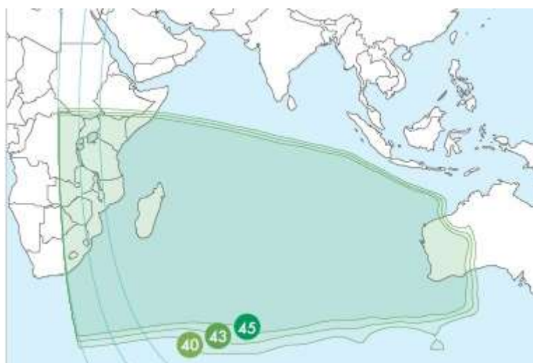
Рис. 19. ЭИИМ (дБ-Вт) в рабочих зонах ИСЗ JCSAT-110А (-15) (110° в.д.) в Ки-диапазоне частот
