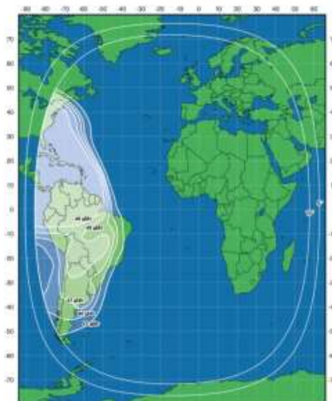
Рис. 51. ЭИИМ (дБ·Вт) в рабочей зоне (3-й фиксированный луч) ИСЗ ЭКСПРЕСС-AM8 (14° з.д.) в Ки-диапазоне частот
