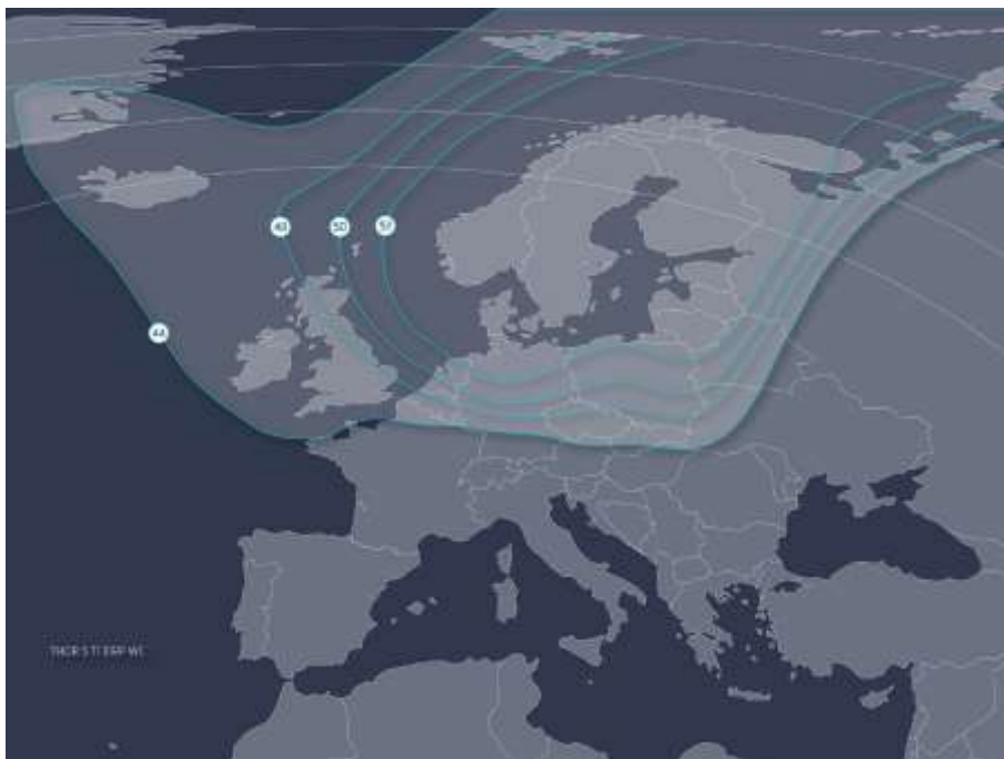
Рис. 3. ЭИИМ (дБ·Вт) в рабочих зонах (Т1) ИСЗ THOR-5 (0,7° з.д.) в Ки-диапазоне частот
