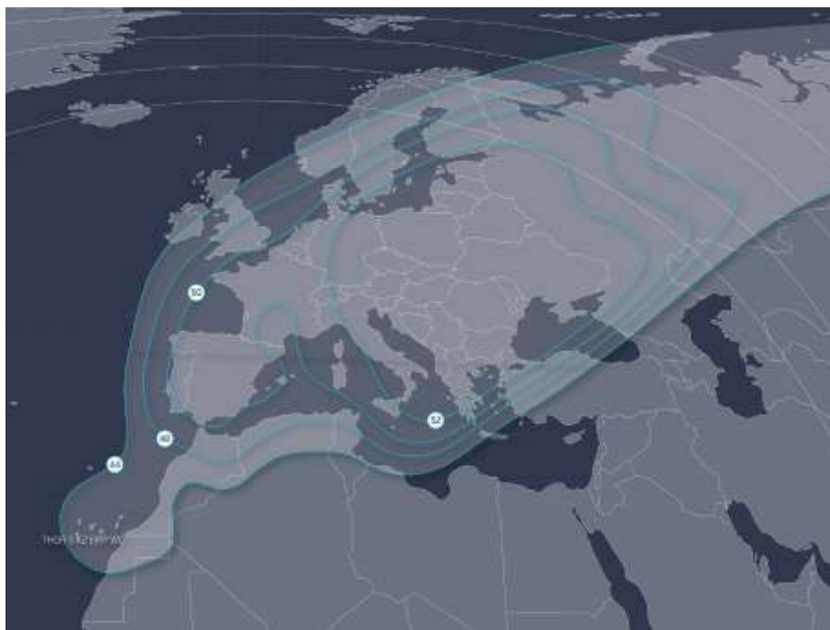
Рис. 7. ЭИИМ (дБ·Вт) в рабочих зонах (K2) ИСЗ THOR-6 (0,8° з.д.) в Ku-диапазоне частот
