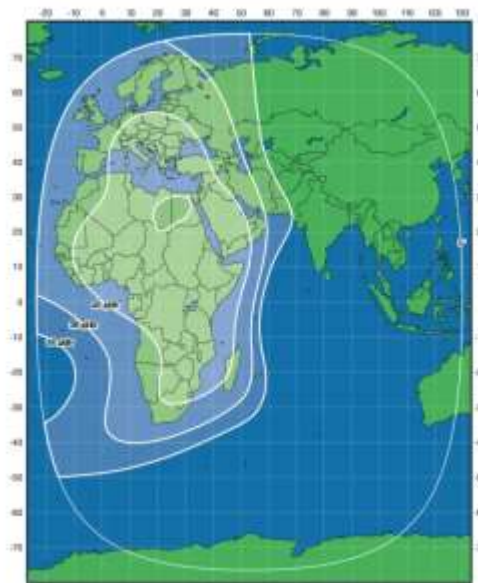
Рис. 30. ЭИИМ (дБВт) в рабочей зоне (африканский луч) ИСЗ ЭКСПРЕСС-АМ6 (53° в.д.) в С-диапазоне частот
