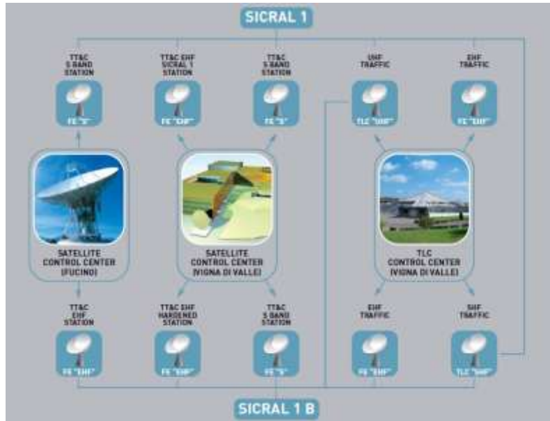
Рис. 3. Состав наземного сегмента системы Sicral-1
