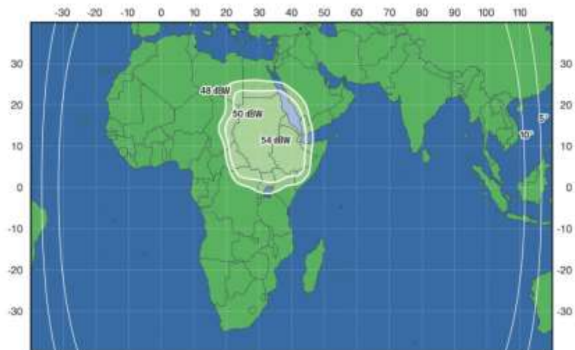
Рис. 44. ЭИИМ (дБВт) в рабочей зоне (1 вариант перенацеливаемого луча) ИСЗ ЭКСПРЕСС-АМ7 (40° в.д.) в Ки-диапазоне частот
