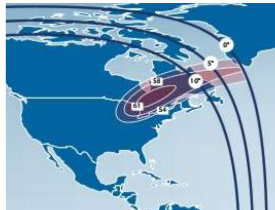
Рис. 38. Рабочие зоны (фиксированная служба) ИСЗ ANIK-F3 (108,75° з.д.) в Ku-диапазоне частот
