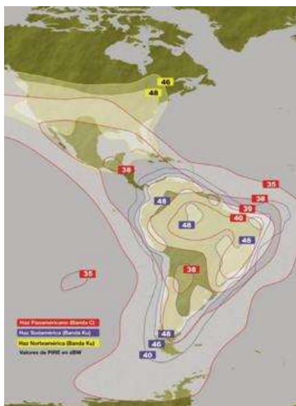
Рис. 23. Рабочие зоны ИСЗ AMAZONAS-2 (61° з.д.) в С- и Ku-диапазонах частот
