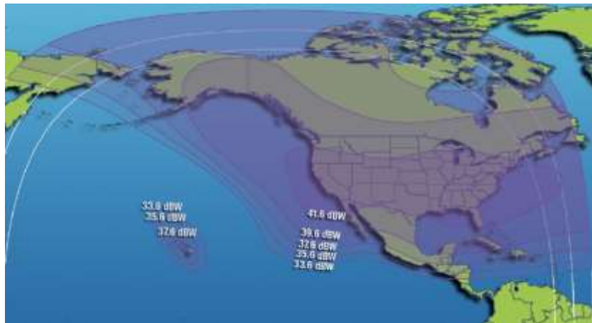
Рис. 54. ЭИИМ (дБ·Вт) в рабочих зонах (вертикальная поляризация) ИСЗ GALAXY-12 (129° з.д.) в С-диапазоне частот
