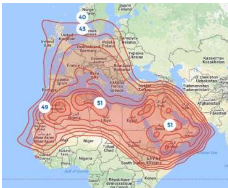
Рис. 4. ЭИИМ (дБ·Вт) в рабочих зонах (FSS) ИСЗ ARABSAT-4B (26° в.д.) в Ku-диапазоне частот
