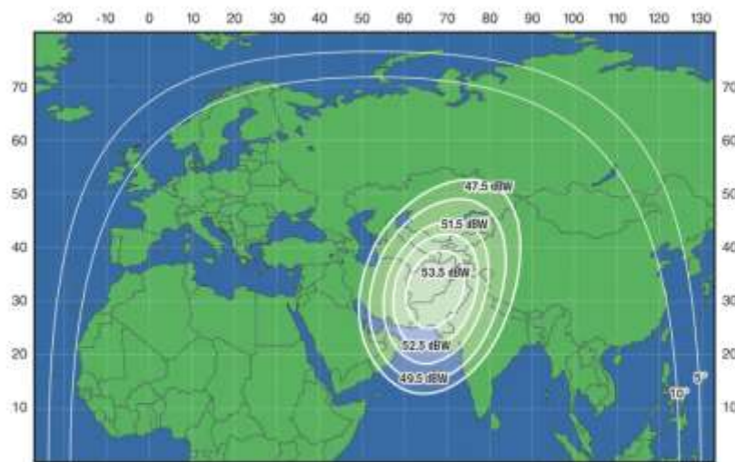
Рис. 35. ЭИИМ (дБ·Вт) в рабочей зоне (вариант 2-го перенацеливаемого луча) ИСЗ ЭКСПРЕСС-АМ6 (53° в.д.) в Ku-диапазоне частот
