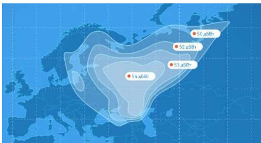
Рис. 52. ЭИИМ (дБ·Вт) в рабочей зоне (1-й фиксированный луч) ИСЗ ЭКСПРЕСС-AMU-1 (36° в.д.) в Ки-диапазоне частот
