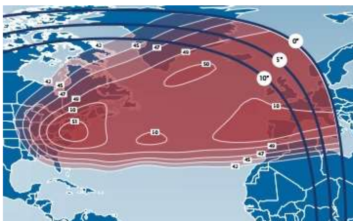
Рис. 52. ЭИИМ (дБ·Вт) в рабочих зонах (восемь узких лучей) ИСЗ TELSTAR-12 VANTAGE (15° з.д.) в Ки-диапазоне частот
