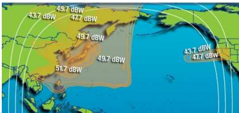
Рис. 100. ЭИИМ (дБ·Вт) в рабочих зонах (северо-запад Тихоокеанской зоны и Калифорния) ИСЗ INTELSAT-19 (166° в.д.) в К-диапазоне частот
