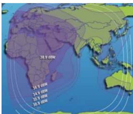
Рис. 89. ЭИИМ (дБ·Вт) в рабочих зонах (а – полуглобальный луч, б – landmass луч, в - западный луч) ИСЗ INTELSAT-17 (66° в.д.) в С-диапазоне частот
