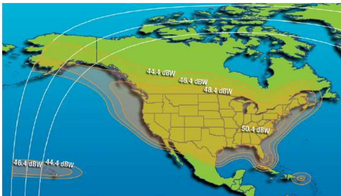
Рис. 75. ЭИИМ (дБ·Вт) в рабочих зонах ИСЗ GALAXY-17 (91° з.д.) в Ku-диапазоне частот
