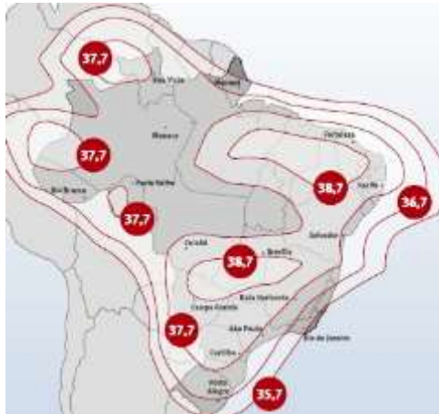
Рис. 2. ЭИИМ (дБ·Вт) в рабочей зоне на Бразилию ИСЗ BRASILSAT-B4 (84° з.д.) в С-диапазоне частот
