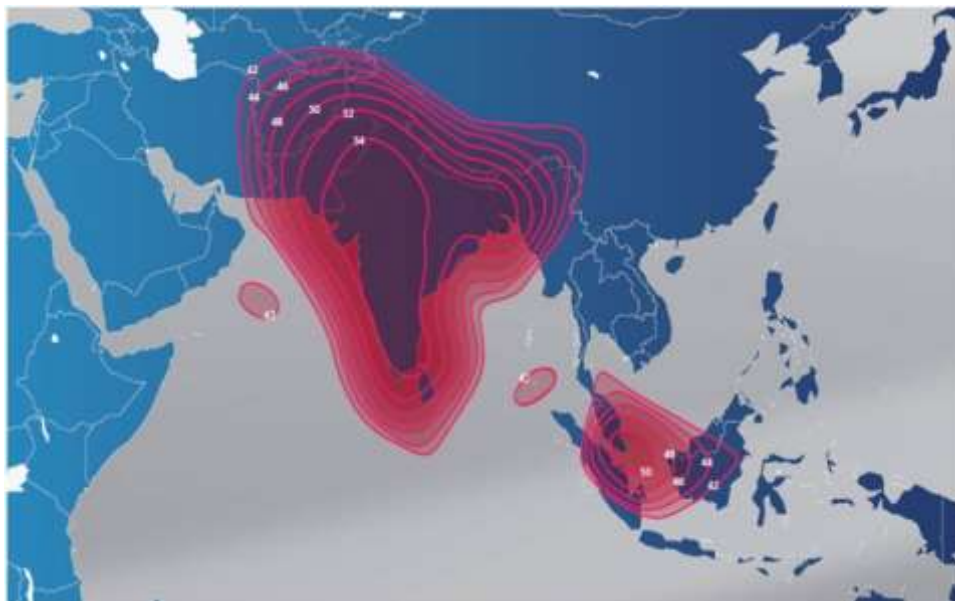
Рис. 33. ЭИИМ (дБ·Вт) в рабочих зонах (Индия и часть Индонезии) ИСЗ ST-2 (88° в.д.) в Ku-диапазоне частот
