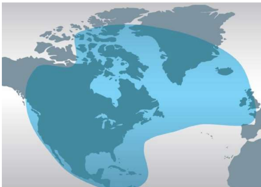
Рис. 101. Рабочие зоны ИСЗ VIASAT-2 (69,9° з.д.) в Ка-диапазоне частот
