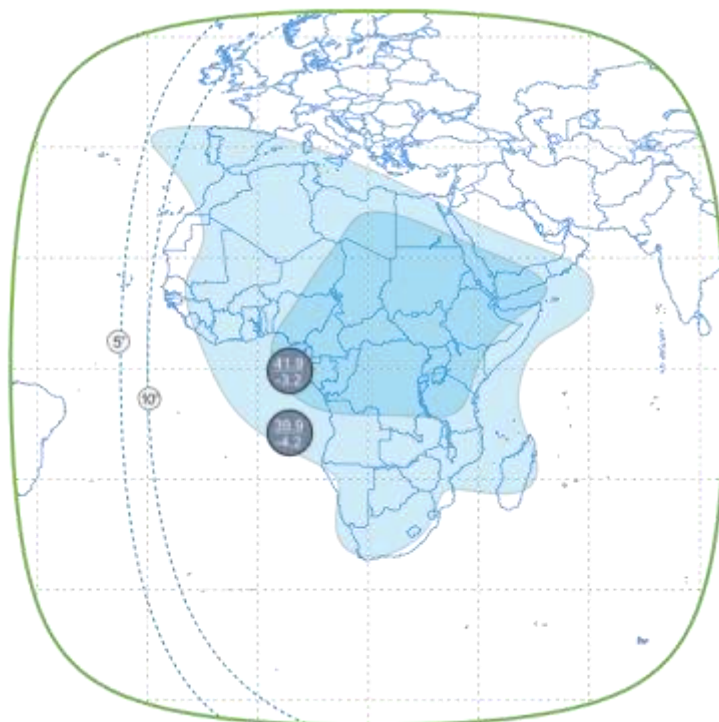
Рис. 3. ЭИИМ (дБ·Вт) в рабочих зонах (африканский луч) ИСЗ BELINTERSAT-1 (51,5° в.д.) в С-диапазоне частот
