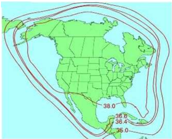
Рис. 11. ЭИИМ (дБ·Вт) в рабочих зонах ИСЗ AMSC и TMI в Ки-диапазоне частот
