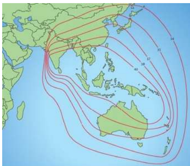
Рис. 16. ЭИИМ (дБ·Вт) в рабочих зонах (а – индийский, б – индонезийский, в - малазийский и г – австралийский лучи) ИСЗ MEASAT-3B (91,5° в.д.) в Ки- диапазоне частот
