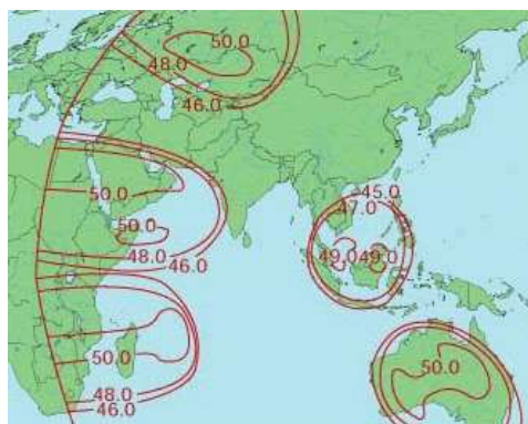
Рис. 5. ЭИИМ (дБ·Вт) в рабочих зонах (варианты перенацеливаемого луча) ИСЗ ASIAsat-3S (105,5° в.д.) в Ku-диапазоне частот
