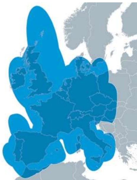
б) Рис. 81. Рабочие зоны (а – на «подсахарную» Африку, б – на западную Европу) ИСЗ EUTESAT-KONNECT (7° в.д.) в Ka-диапазоне частот
