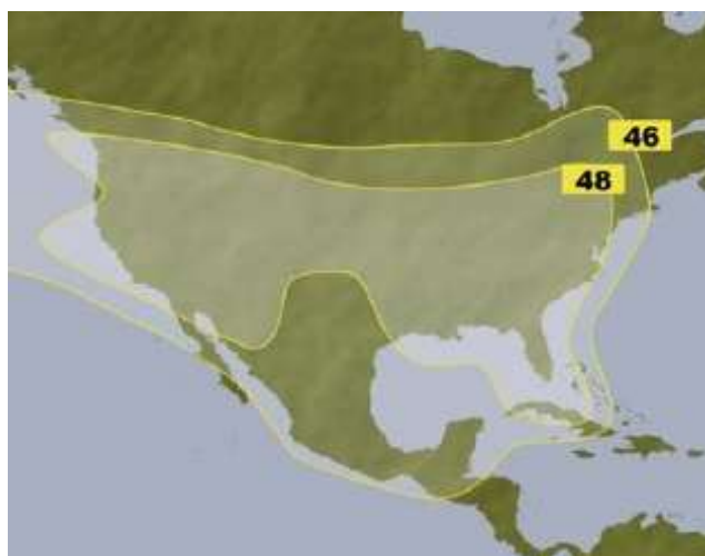
Рис. 25. ЭИИМ (дБ·Вт) в рабочей зоне (на Северную Америку) ИСЗ AMAZONAS-2 (61° з.д.) в Ки-диапазоне частот
