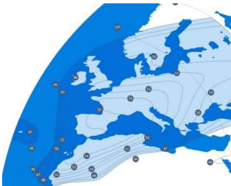
Рис. 15. ЭИИМ (дБ·Вт) в рабочих зонах (на Европу) ИСЗ HISPASAT-36W-1 (36° з.д.) в Ки-диапазоне частот
