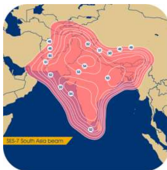
Рис. 53. Рабочие зоны ИСЗ SES-7 (108,2° в.д.) в Ku-диапазоне частот
