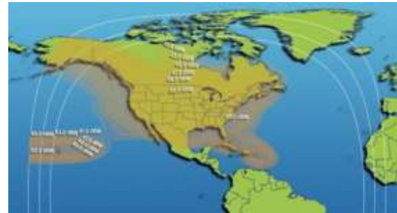
Рис. 66. ЭИИМ (дБ·Вт) в североамериканской рабочей зоне ИСЗ GALAXY-28 (INTELSAT-A8, 89° з.д.) в Ku-диапазоне частот
