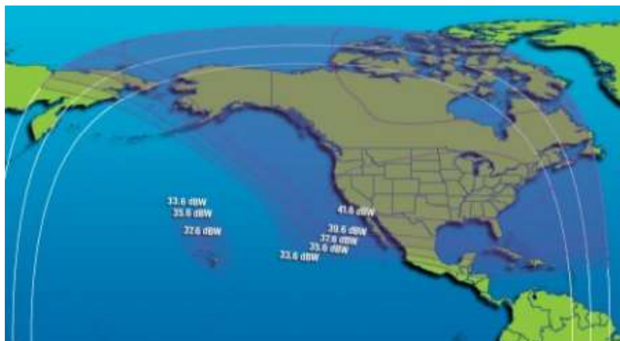
Рис. 72. ЭИИМ (дБ·Вт) в рабочих зонах ИСЗ GALAXY-15 (133° з.д.) в С-диапазоне частот
